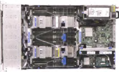
32 CPU-Kerne und bis zu 1,5 TByte RAM auf zwei Rack-Höheneinheiten: HP ProLiant DL560
