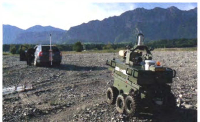
Artor (ETH Zürich) folgte dem Führungsfahrzeug zumeist recht flott, hatte aber immer wieder Schwierigkeiten mit kleinen Steinen, die sich zwischen Räder und Chassis schoben.
