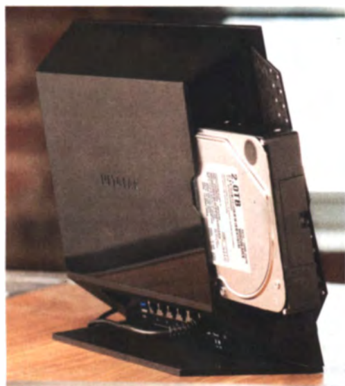
Dank eines Einschubs lassen sich im WNDR4700 installierte Festplatten ohne Werkzeug schnell austauschen.
