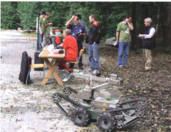
Beim Aufklärungsszenario erzielten ferngelenkte Roboter wie hier der Telemax die besten Ergebnisse ...
