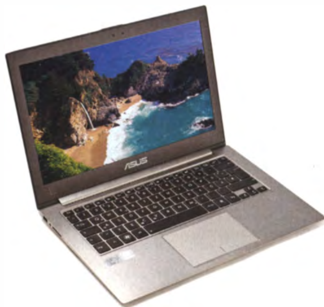
Asus baut in das edle Unibody-Gehäuse des ZenBook Prime UX31A (13,3 Zoll) ein mattes Full-HD-Panel ein. Der Akku hält bis zu 9 Stunden durch.
