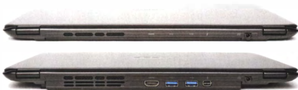
Die motorisierte Klappe des Acer Aspire S5-391 schützt die Schnittstellen beim Transport vor Staub. Ausgefahren machen sie das Notebook hinten einen halben Zentimeter dicker.
