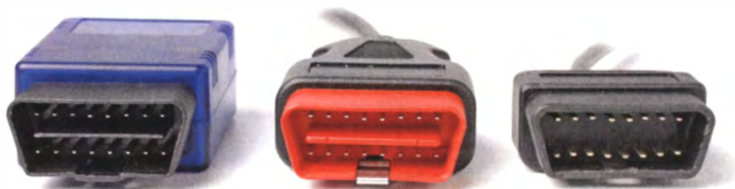
Mechanische Unterschiede: OBD2-Stecker und Adapter in einem, der sehr gute rote Stecker des OBDLink Wifi und der lausige des PLX Kiwi.
