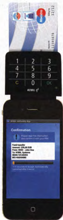
Das Kartenterminal von Kobil kommuniziert über die Audio-schnittstelle mit dem Smartphone.
