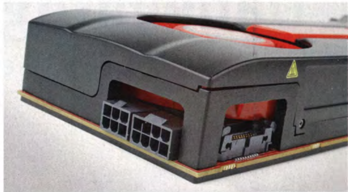
Die beiden rund 28 Zentimeter langen FirePros bringen einen Anschluss für die S400-Zusatzkarte mit. Die W9000 speist sich aus einer sechs- und achtpoligen Buchse, der W8000 genügen zwei Sechser.
