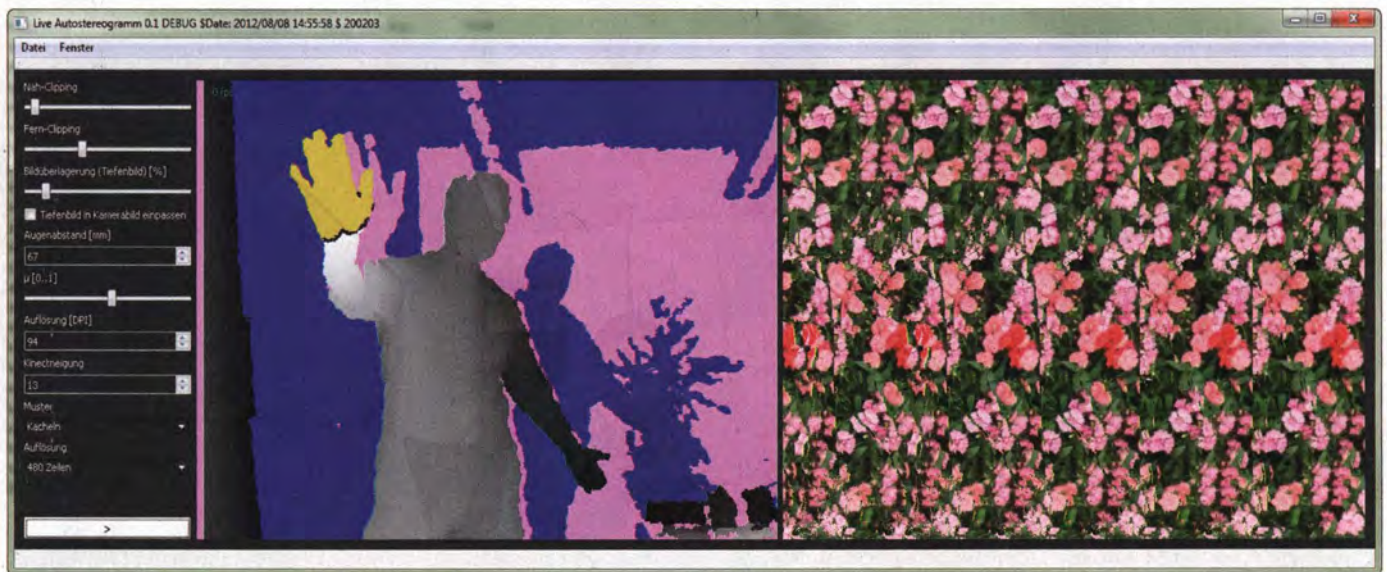
Die Beispielanwendung „Bineqt“ vereint die Tiefenbilder der Kinect mit einem Muster nach Wahl und berechnet daraus – vorausgesetzt, der Rechner ist schnell genug – in Echtzeit Autostereogramme.
