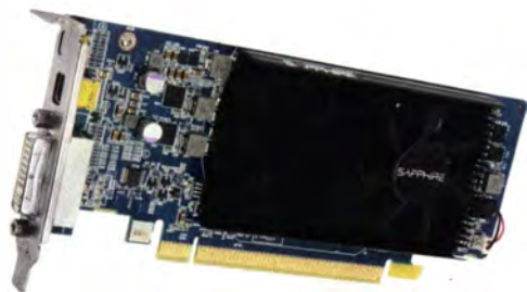
Sapphires Spezialversion der Radeon HD 7750 bringt viel 3D-Leistung in sehr kompakte Gehäuse.
