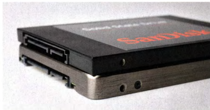
In herkömmliche Notebooks passen SSDs mit 9,5 Millimeter Höhe (unten). Subnotebooks oder Ultrabooks fordern dagegen die schlanken 7-mm-Exemplare (oben).
