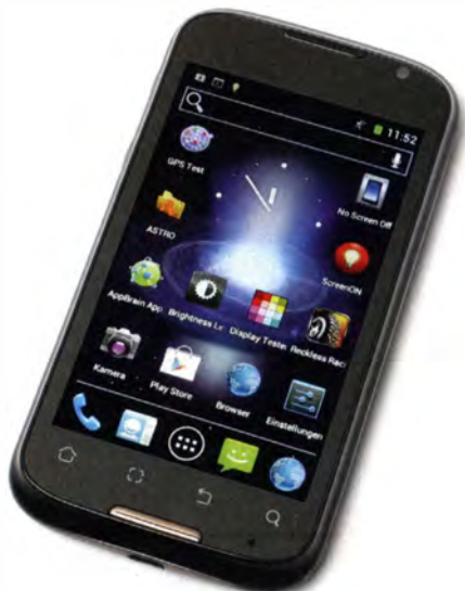
Simvalley SP-120 hat ein gutes 4-Zoll-Display und einen Dual-SIM-Slot. Die Betriebssoftware, Android 4.0, ist aktueller als bei der Konkurrenz, ruckelt aber.
