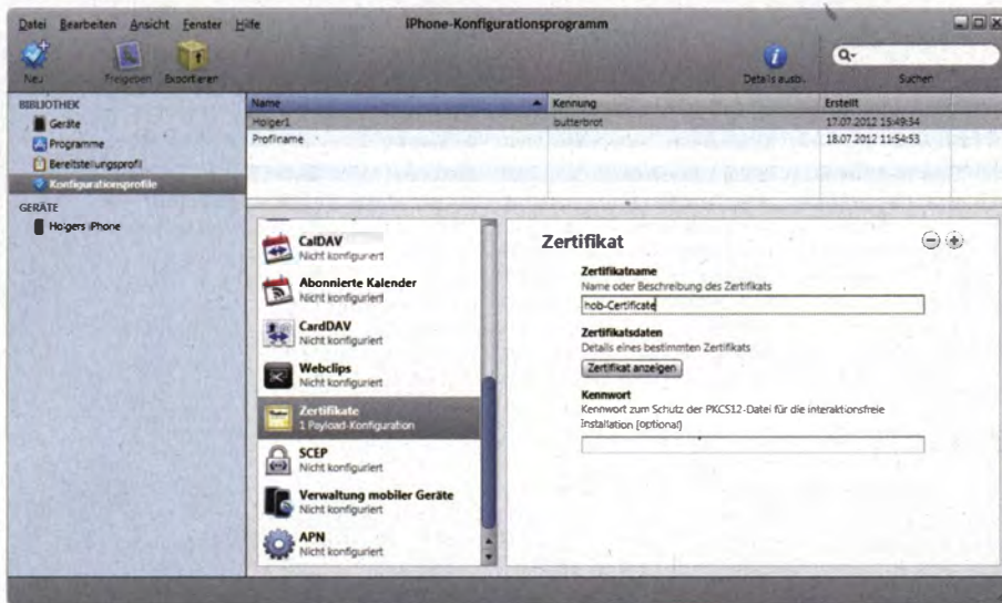
Mit dem iPhone-Konfigurationsprogramm lassen sich S/MIME-Zertifikate in einem Profil via USB auf das Smartphone übertragen.
