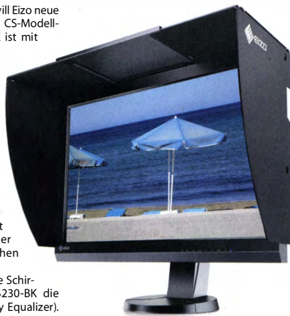
Über den eingebauten Sensor kann sich Eizos 24-Zöller selbstständig kalibrieren.
