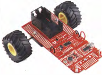
MiniBot: Hat man genug vom Prototypen, so bricht man die Platinen auseinander und baut sich einen neuen Roboter.
