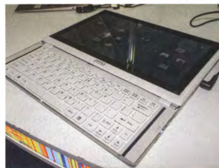
Wie auf Schienen: Das MSI Slider versteckt eine Tastatur unter seinem berührungsempfindlichen Display.
