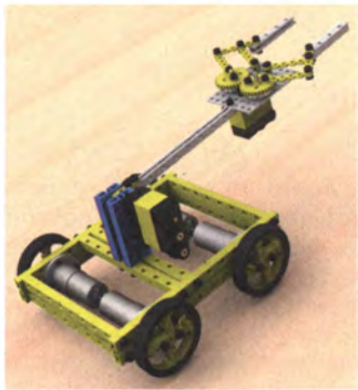
Makeblock: Bauteile aus Aluminium geben den eigenen Robotern eine hohe Stabilität und ermöglichen dennoch flexible Konstruktionen.
