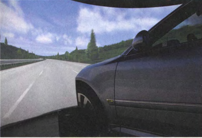
Im Fahrsimulator prüft Audi, wie sehr die Prototypen neuer Bedienelemente den Fahrer in Spurhaltegenauigkeit und Blickführung beeinflussen.
