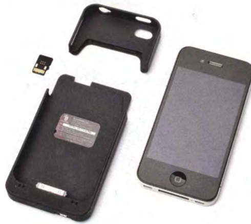
Die Handy-Schale vom Hersteller Moneto ergänzt ein iPhone um ein NFC-Modul und eine SIM-Karte mit Secure Element.
