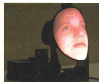
Der Mask-Bot von der TU München hält sich nicht mit mechatronischen Feinheiten auf, sondern erzeugt ein Robotergesicht per Hintergrundprojektion.
