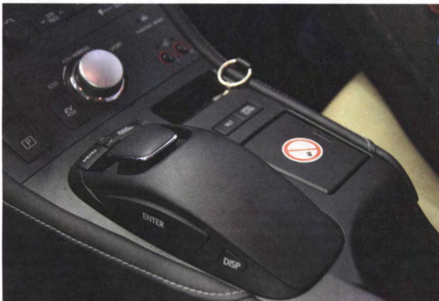
Lexus verwendet diesen Trackball-artigen Finger-Joystick mit Force Feedback zur Eingabe. Das funktioniert sehr gut.
