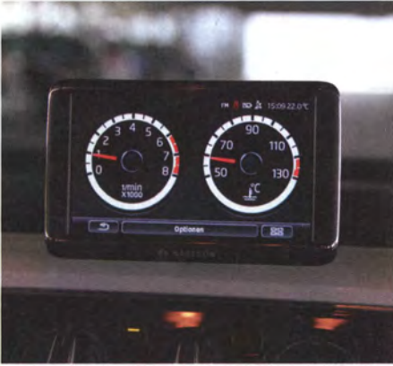
VWs Kleinwagenlösung im Up: Ein angepasstes Navigon-Gerät zeigt auch Fahrzeuginformationen an und steuert das Radio.
