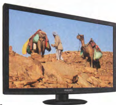
Ein VA-Panel verhilft Philips' 27-Zöller zum kontrastreichen und blickwinkelstabilen Bild.
