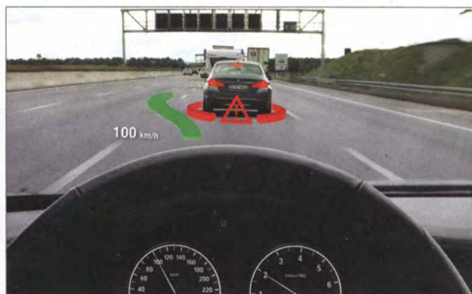
Augmented Reality im Head-up-Display: Gefährliche Hindernisse und Ausweichmöglichkeiten werden auf der Windschutzscheibe markiert.
