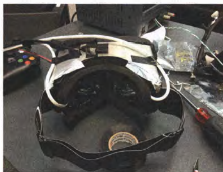
Den Prototypen des Rift genannten VR-Helms von Oculus montierte John Carmack mit Klebeband an eine Skibrille.
