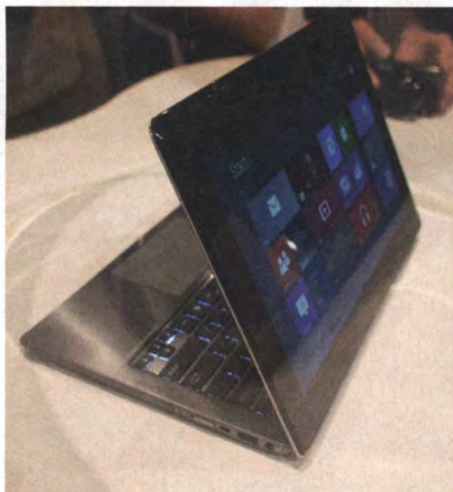
Asus spart sich komplizierte Klappmechanismen und packt ein zweites Display auf die Außenseite des Ultrabooks Taichi.
