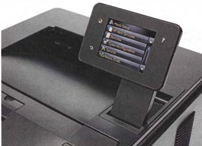
HP spendiert seinem Laserjet Pro M401dn einen nützlichen USB-Host-Anschluss und ein Farbdisplay für den Direktdruck.
