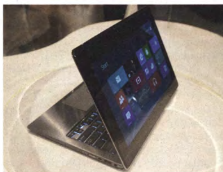
Zwei in eins: Das Asus Taichi besitzt zwei Displays im Deckel, das äußere glänzt mit Touchscreen.
