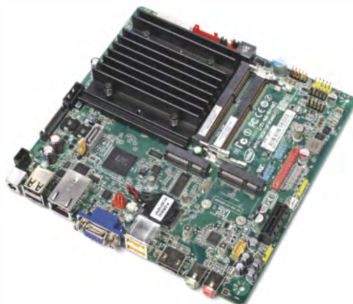
Intel DN2800MT: dank direkter 12-Volt-Speisung sehr genügsam
