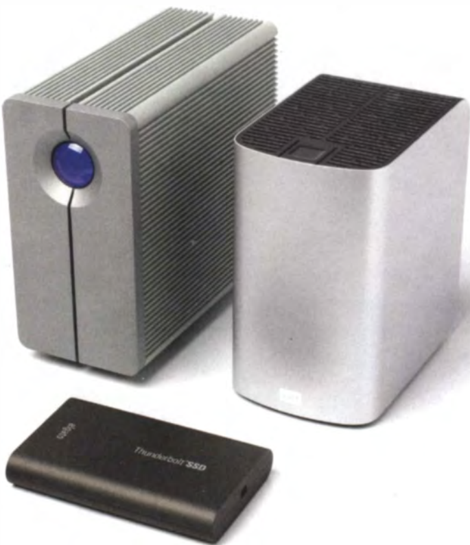
Elgatos SSD (unten) ist leicht und schnell bei geringer Kapazität. Die ebenfalls recht flotten Doppelfestplatten von LaCie (links oben) und Western Digital fassen bis zu 6 TByte an Daten.
