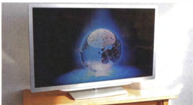
Der Fernseher von Philips zeigt dank seiner nanostrukturierten Oberfläche im Sonnenlicht nur wenig Reflexionen.
