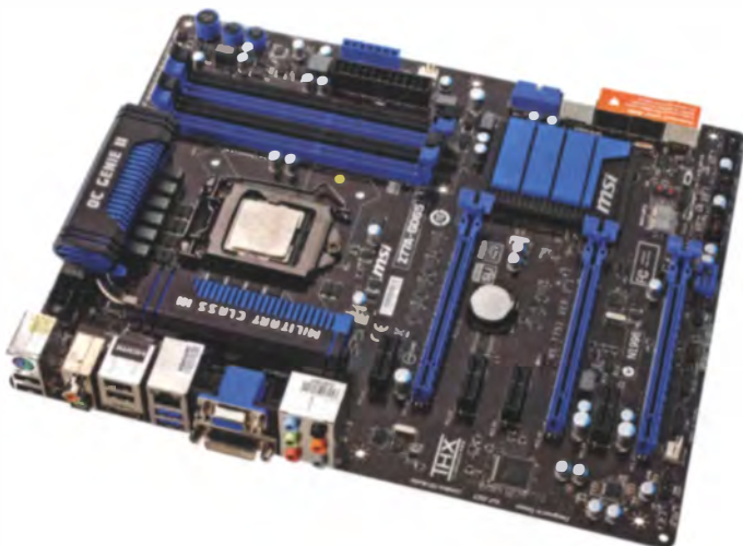
MSI Z77A-GD65: typisches 180-Euro-Board mit drei PEG-Slots, vielen Zusatzchips und Übertaktungsfunktionen
