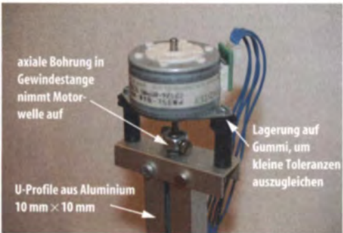
Die vertikalen Achsen: Die Übersicht und die Detailaufnahme des Motors zeigen die linke Seite der Maschine, die Führung des heißen Drahtes wurde auf der rechten Maschinenseite aufgenommen.
