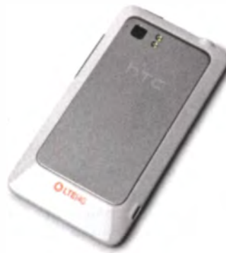
SIM- und MicroSD-Karte lassen sich nur wechseln, indem man den Akku herausnimmt.
