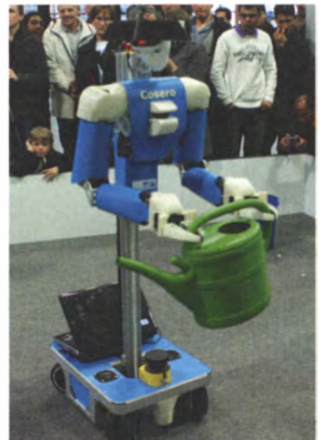
Dank eines 3D-Scanners konnte der NimRo-Roboter selbstständig Modelle der Gegenstände lernen, mit denen er hantieren soll.
