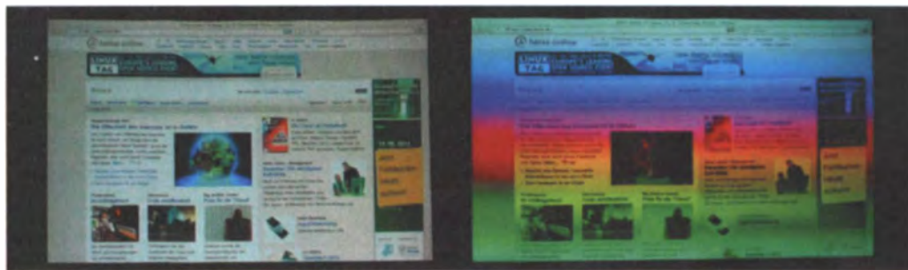
So sieht es die Videokamera: Links die Projektion eines LCD-Beamers, rechts die eines DLP-Geräts. Mit bloßem Auge nimmt man diesen Regenbogeneffekt natürlich nicht so stark wahr, bei schnellen Kopfbewegungen sind aber Farbbliitzer zu sehen.
