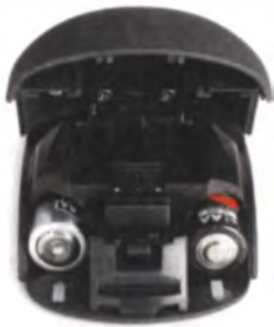
Den USB-Empfänger für die drahtlosen Eingabegeräte des ThinkCentre 91z versteckt Lenovo im Batteriefach der Maus.
