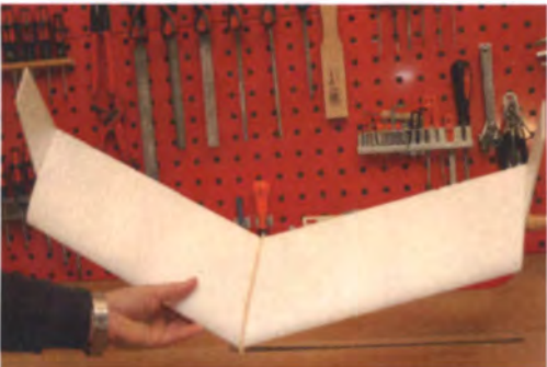
Schneiden, montieren, fliegen: Ein unbeplanckter, frei fliegender Nurflügel entsteht auf der Eigenbaumaschine PCHotwire mit wenig Aufwand und dennoch hoher Präzision.
