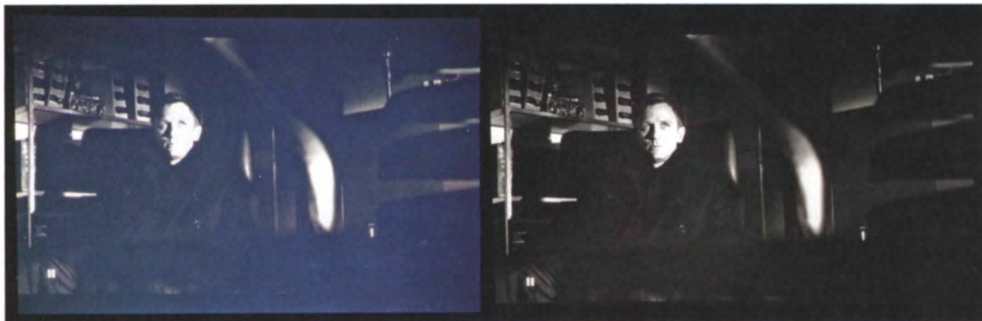
Flau: Die Projektion der günstigen LCD-Geräte (links) ist deutlich kontrastärmer als die der gleich teuren DLP-Beamer.
