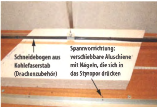
Hier liegt ein Styroporblock mit trapezförmigem Grundriss als Tragflächenrohling in der Mitte der Maschinenrundplatte.
