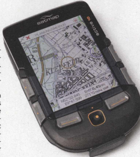
Das große Display des SatMap Active 10 zeigt nur Rasterkarten, mit denen das tastengesteuerte Gerät effizient umgeht.
