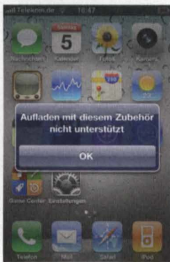
Das iPhone 4 weigert sich, mit dem Ladegerät von Busch+Müller zusammenzuarbeiten – einfache Abhilfe ist nicht möglich.
