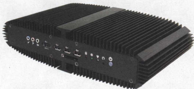
Im spo-book NEO sitzt ein passiv gekühlter Core-i-Mobilprozessor mit zwei Kernen und integrierter GPU.
