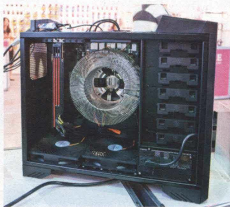
Der gigantische CPU-Kühler Nofan CR-100A soll Prozessoren mit bis zu 100 Watt Leistungsaufnahme passiv kühlen.
