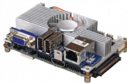
Der Dual-Core-Prozessor Eden X2 auf dem EPIA-P900 braucht einen aktiven Kühler.
