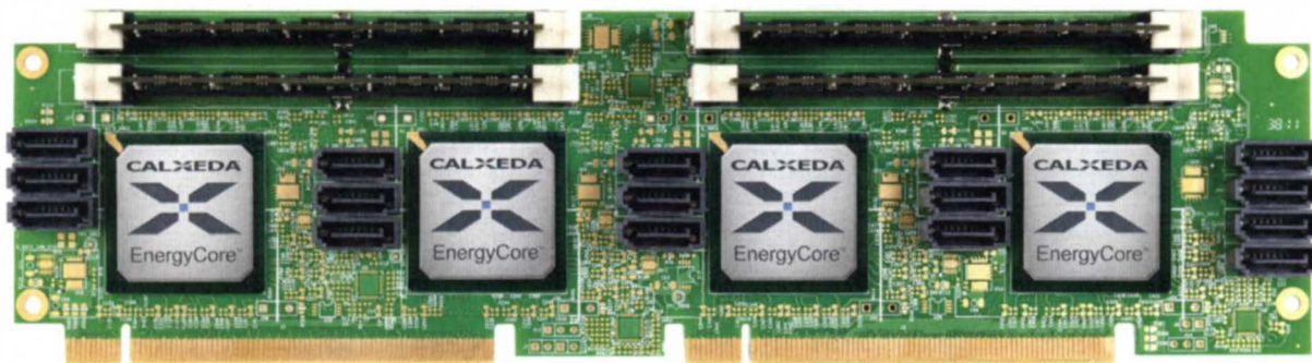
Jede EnergyCard von Calxeda vereint vier Server-Nodes mit je vier ARM-Kernen und 4 GByte ECC-RAM.
