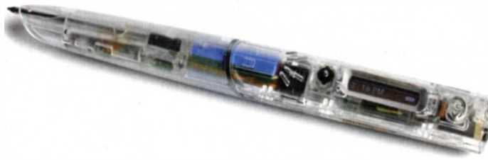
Eine Spezialversion des Digitalstifts LiveScribe Echo mit transparentem Gehäuse zeigt dessen gedrängte Innereien.
