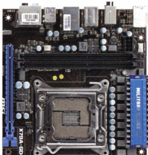
Intels LGA2011 für Core i7-3900: teure High-End-Plattform mit PCIe 3.0
