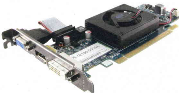
AMDs Radeon HD 6450 (links) und Nvidias GeForce GT 520 passen auch in sehr flache Gehäuse. Ihre modernen Videoeinheiten helfen bei der Wiedergabe von 3D-Blu-rays.
