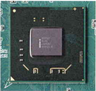
Das Chipsatz-Stepping ätzt Intel ins Silizium – doch das ist unter einem Kühler versteckt.
