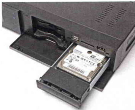
Klick und raus: Dank Festplatten- einschub an der Front des VT-1C+ lässt sich eine interne Festplatte schnell entfernen.
