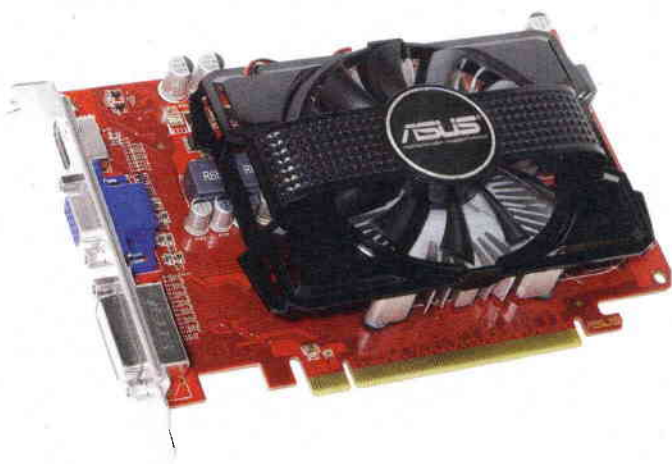
Die Radeon HD 6670 ist auch unter Last vergleichsweise sparsam und kommt deshalb ohne 6-poligen Stromanschluss aus.
