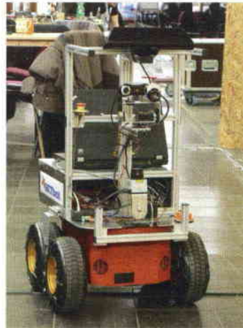
Der Kinect-Sensor ermöglicht nicht nur Haushaltsrobotern wie NimbRos Dynamaid die Orientierung, ...
