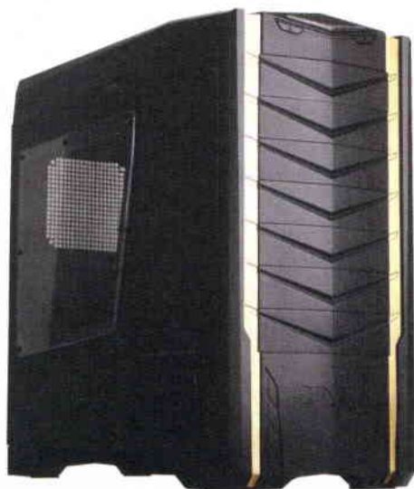
Steckplätze oben, Netzteil unten: Im PC-Gehäuse Raven 3 ist nichts am üblichen Platz.
