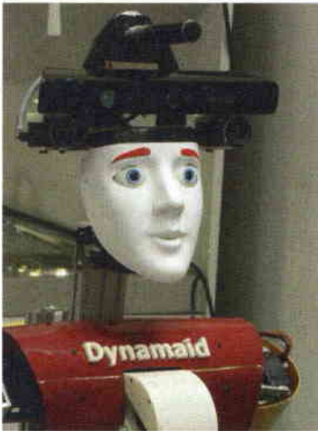
Der Kinect-Sensor ermöglicht nicht nur Haushaltsrobotern wie NimbRos Dynamaid die Orientierung, ...
