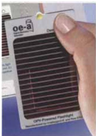
Diese gedruckte Taschenlampe vereint organische Solarzelle, Li-Ion-Akku und LED.
