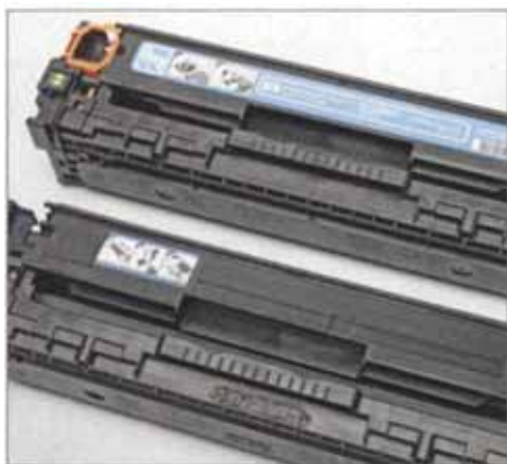
Recycling-Kartuschen erkennt man oft an den per LötKolben unkenntlich gemachten Seriennummern und Herstellernamen.
