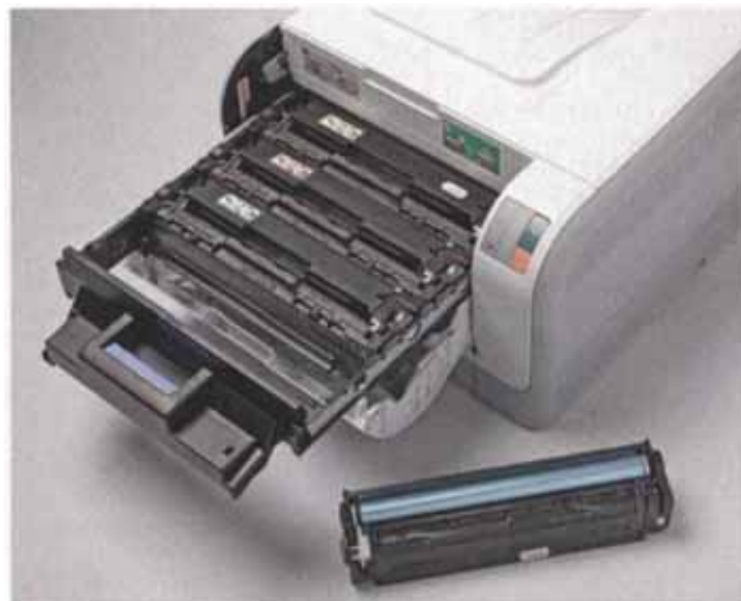
Die Tonerkartuschen des HP CP1215 enthalten außer dem Farbbehälter auch die Bildtrommel; über eine ausziehbare Lade lassen sie sich bequem austauschen.
