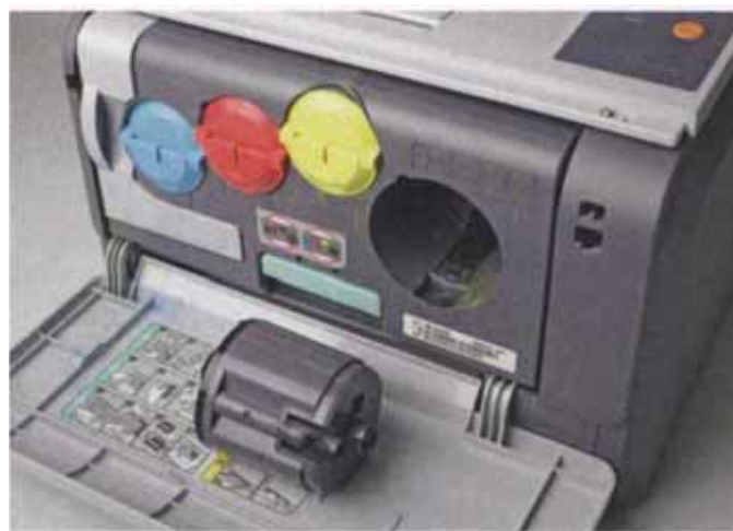
Beim Samsung CLP-300 wechselt man nur den Tonerbehälter aus. Eine seitliche Führungsnut verhindert ein Verwechseln der zylinderförmigen Kartuschen.
