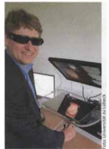
Mit Shutterbrille und haptischem Kraftrückkopplungsgerät trainiert ein Mediziner das Punktieren.
