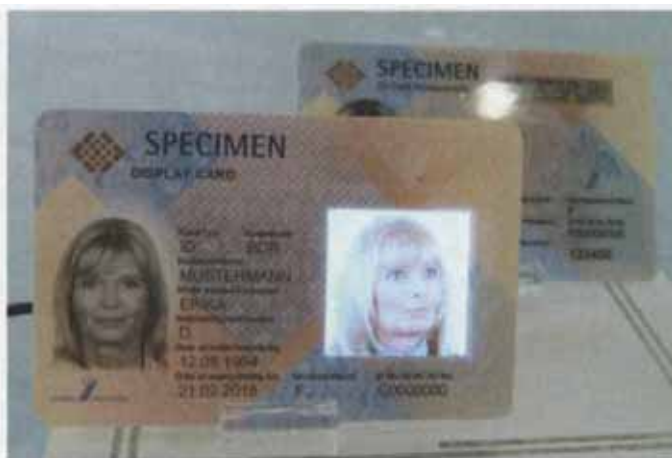
Der Personalausweis mit integriertem OLED-Videobild ist eines der Ergebnisse im Projekt Secudis der Bundesdruckerei.
