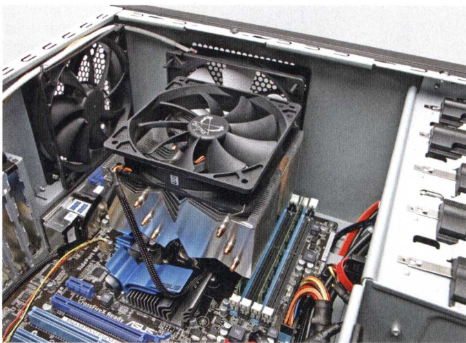
Der CPU-Kühler Rasetsu ist so groß, dass man ihn am besten vor dem Einbau des Mainboards montiert.
