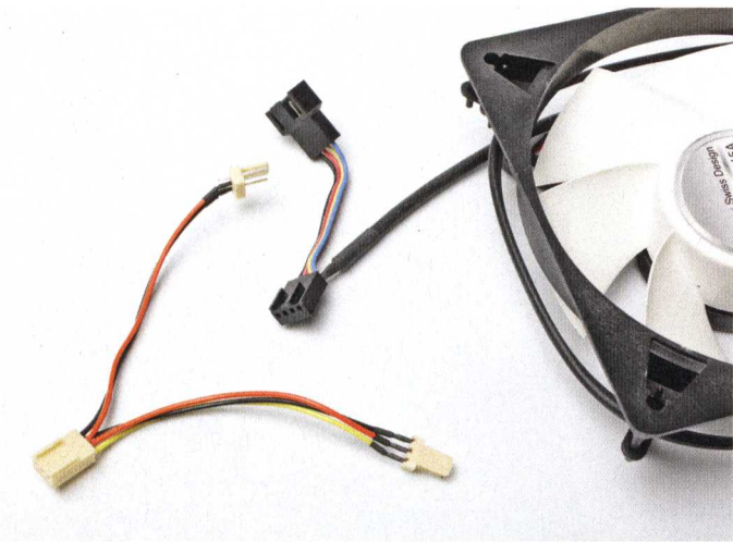
Über Y-Adapter kann man mehrere PC-Lüfter an einem Board-Anschluss betreiben – sofern dieser genug Strom liefert.
