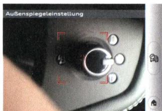
Audis eKurzinfo wertet das Live-Bild der iPhone-Kamera (li.) aus und liefert Infos zu den aufgenommenen Bedienelementen.
