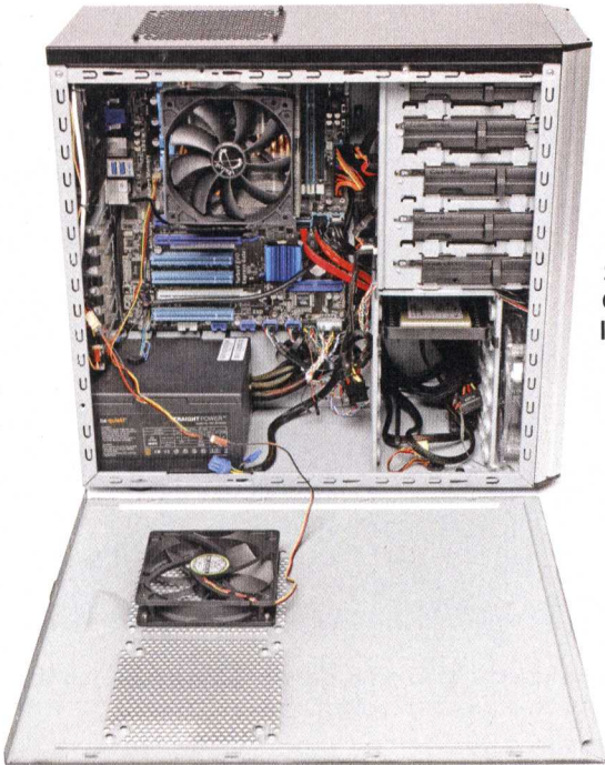
Die drei Gehäuselüfter schaffen zusammen das Kunststück, die Abwärme des Sechskern-Prozessors von AMD leise aus dem Gehäuse zu befördern und die Grafikkarte mit Frischluft zu versorgen.
