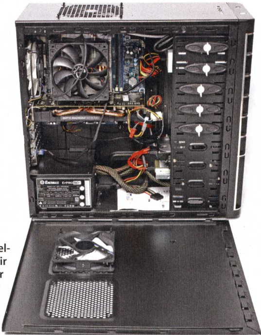
Die drei Gehäuselüfter schaffen zusammen das Kunststück, die Abwärme des Sechskern-Prozessors von AMD leise aus dem Gehäuse zu befördern und die Grafikkarte mit Frischluft zu versorgen.
