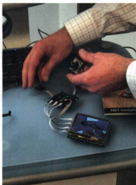
Mit dem programmierbaren Elektronik-baukasten .NET Gadgeteer können auch junge Forscher erste Prototypen basteln.
