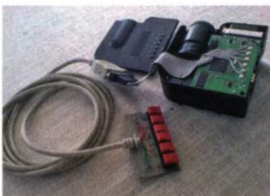
Comeback für ein ausgedientes Centronics-Druckerkabel: Ein preiswerter Minibeamer, der normalerweise nur über sechs in seinem Gehäuse eingebaute Tasten zu steuern ist, erhält so eine Fernbedienung.
