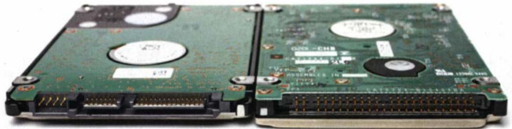
Eine SATA-Festplatte (links) erkennen Sie an der flachen Kontaktleiste, ein IDE-Modell an der doppelten Reihe dünner Pins.
