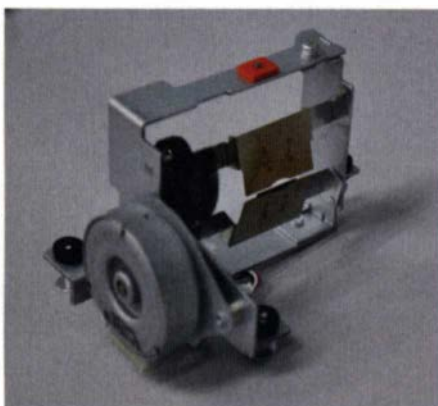
In vielen Projektoren kommen adaptive Blenden zum Einsatz, hier das Modell „Flügelblende mit Schrittmotor“ von Epson.
