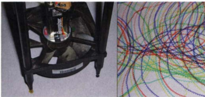
An die Schwünge und Bögen von „Spirograph“-Zeichnungen erinnert das, was der aus einem PC-Lüfter gebaute Einfachst-Malroboter mit vier Filzschreibern produziert. Den Strom liefert eine 9-Volt-Blockbatterie.
