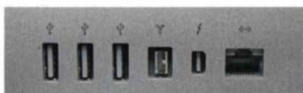
Das Thunderbolt Display verhilft jedem Mac zu FireWire 800 und Gigabit-Ethernet.
