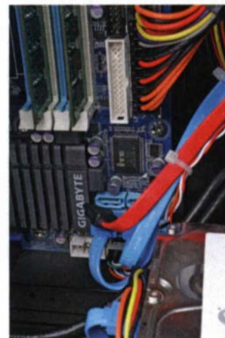
Kleiner Lapsus: Im One Computer AMD A8-3850 war das SATA-Kabel für den eSATA-Frontanschluss lose.
