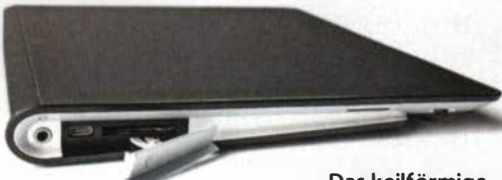
Das keilförmige Kunststoff-Gehäuse erleichtert das Tippen und bietet genügend Platz für normalgroße SD-Karten.
