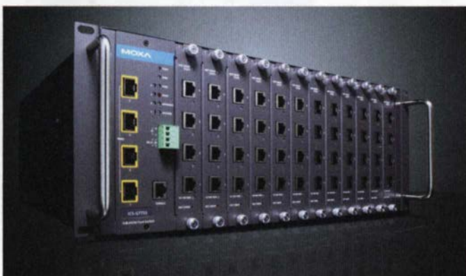
Moxa bezeichnet die Industrie-Switches der ICS-G7000er-Serie als die ersten mit 10-Gigabit-Ethernet.
