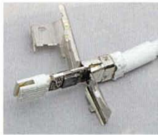
Apples teure Thunderbolt-Kabel besitzen Transceiver-Chips in den Steckern.
