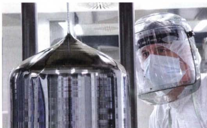
Siltronic fertigt unter anderem in Burghausen Wafer aus Silizium-Einkristallen (Foto) und beliefert alle großen Chip-Hersteller.
