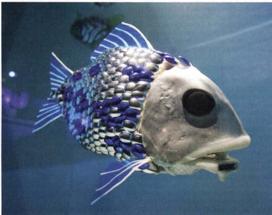
Der Roboterfisch Shoal nutzt zum Antrieb eine mechanisch angetriebene Schwanzflosse.
