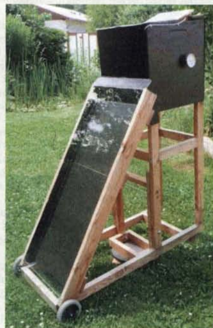
Der Solardörrer nutzt einen PC-Netzteil-Lüfter und Computer-Gehäuseteile.
