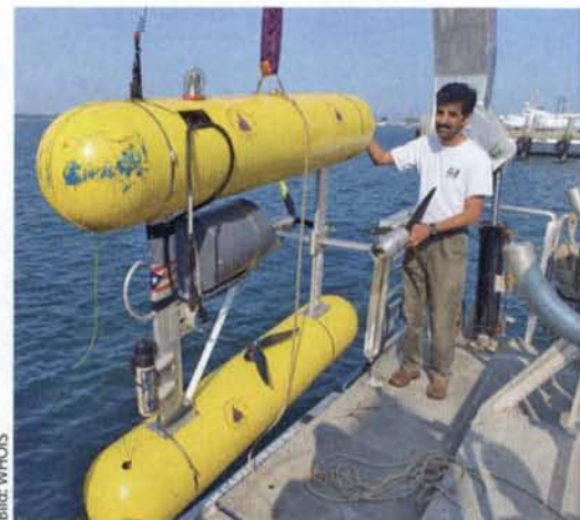
SeaBEDs Torpedo-Rümpfe liegen nicht nebeneinander, sondern im Wasser übereinander.
