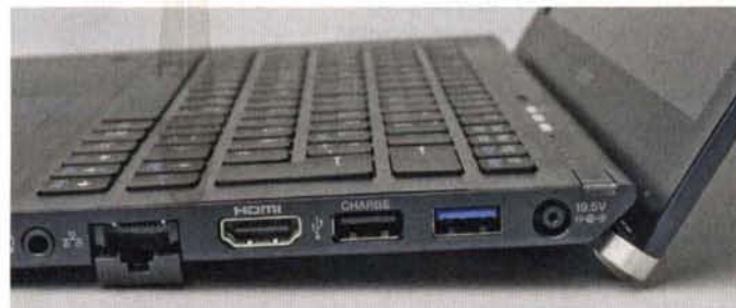
Der aufgeklappte Deckel bockt den Rumpf hinten einen halben Zentimeter in die Höhe; erst dann lässt sich die LAN-Buchse nutzen.
