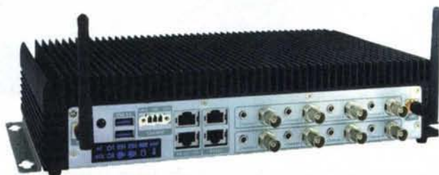
Tank-700: passiv gekühlter PC mit analogen Video-Anschlüssen und galvanisch isolierten Schnittstellen
