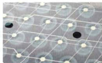
Von links: Tastatur mit Mikroschaltern, mit Folientechnik (einmal von oben, einmal von unten) und mit Scherenmechanik
