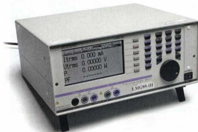
Für Messungen der Leistungsaufnahme am 230-V-Anschluss eines Testkandidaten verwenden wir das hochpräzise LMG95, das aber nur mit je einem Kanal Strom und Spannung überwacht.
