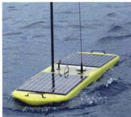
Surfbrett mit Solarzellen: Der Schwimmroboter Wave Glider erzeugt seine Energie aus Wellen- und Sonnenkraft.
