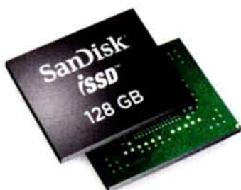
Bei SanDisks iSSD im \mu SSD-Format beschleunigt ein nichtflüchtiger SLC-Flash-Cache Schreibzugriffe.
