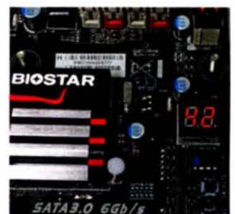
Die Temperatur des Hauptprozessors gibt die 7-Segment-Anzeige des TA75M+ in Echtzeit aus.
