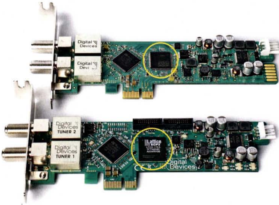
Bei der neuen Revision 6 (unten) der Digital Devices CineS2 wurde der Micronas-nGene-Chip der Revision 5.4 (oben) durch einen FPGA von Lattice ersetzt. Linux-Treiber gibt es nur für die alte Variante.
