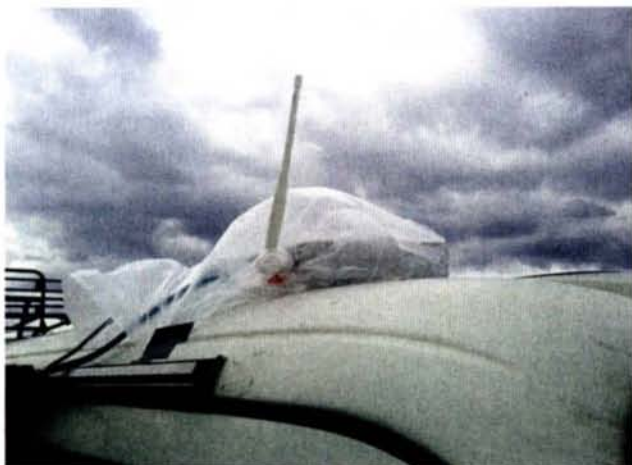
Eine wetterfest verpackte WLAN-Basisstation mit OpenWRT soll vorübergehend das Camp-Netzwerk in abgelegene Zelte verteilen.
