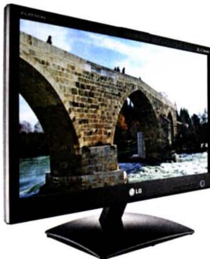
Dank nachgeführter Parallaxenbarriere braucht man bei LGs 3D-Monitor D2000 keine 3D-Brille.
