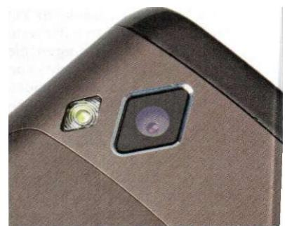
Die Autofokus-Kamera des S8500 Wave liefert bessere Bilder als die des iPhone 4, ein Fotolicht erhellt maximal einen Meter entfernte Motive.
