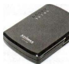
Der Edimax 3G-6210n ist ein tragbarer Mini-Router mit Ethernet-Schnittstelle, ausgelegt für ein externes USB-Modem.
