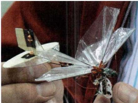
Derzeit leider noch nicht flugfähig: Wenn die fehlende Elektronik ausgeliefert ist, soll diese Roboterlibelle bis zu sechs Minuten in der Luft bleiben – und Kamerabilder übermitteln können.
