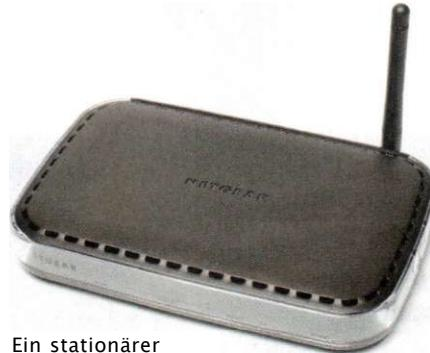
Ein stationärer Router ohne Modem, aber mit immerhin vier LAN-Ports:
