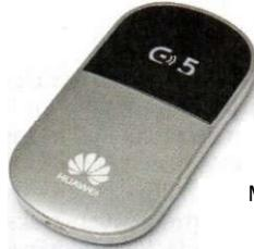
Der Huawei E5 lässt sich via WLAN als Router und per USB als Modem am Laptop nutzen.
