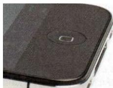
**Die drei Segmente des iPhone-4-Stahlrahmens dienen als Antennen für GSM, UMTS, WLAN, Bluetooth und GPS. Überbrückt man die unteren Segmentgrenzen mit der Hand, sinkt die Signalanzeige deutlich.**
