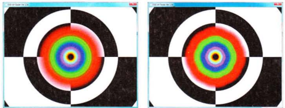
Der AF-Tester visualisiert die Mip-Map-Stufen. Sind die Ringe rund, arbeitet der Filter optimal. AMD hat den AF-Algorithmus bei der HD-5000-Serie (links) im Vergleich zur Vorgängergeneration stark verbessert und ist sogar näher am Optimum als Nvidias GTX-400-Karten (rechts).
