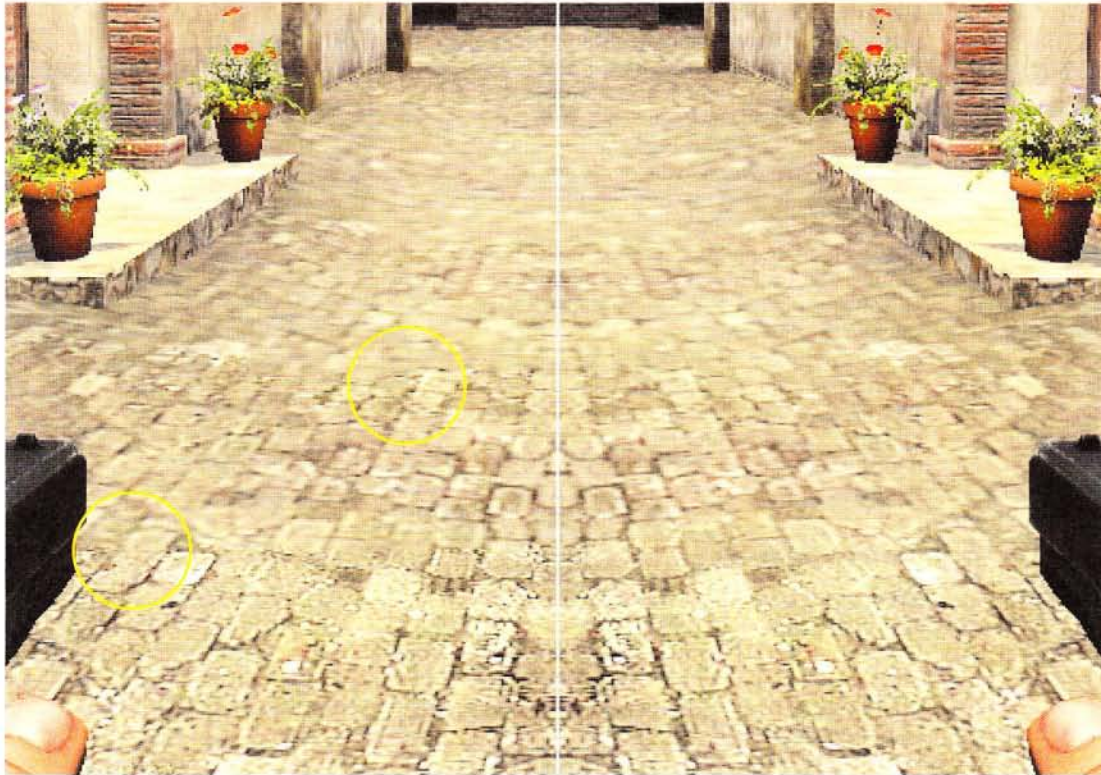
Der bilineare Filter (links) zeigt als lästige Nebenwirkung die Übergänge zwischen verschiedenen Texturstufen. Der trilineare Filter kaschiert sie, behebt aber nicht die Unschärfe im Hintergrund.
