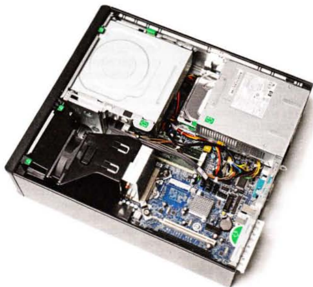
An alle wichtigen Komponenten der Workstation Z200 kommt man dank praktischer Klappmechanismen schnell heran.
