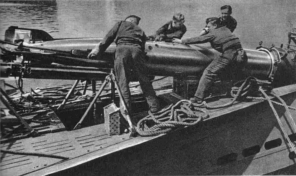
Torpedos werden an Kränen übers Boot gehievt und auf der schrägen Ladeschiene in den Bugraum hinabgelassen. Solange sie nicht verschossen sind, schränken diese „Aale“ den Wohnraum der Besatzung ein, der ohnedies sehr eng ist.
