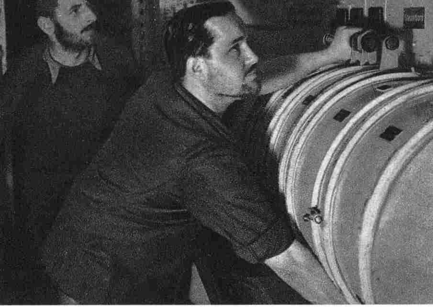
Die E-Maschinen werden auf die Schraubenwellen geschaltet. Stark vorlastig geht das Boot auf Tiefe.
