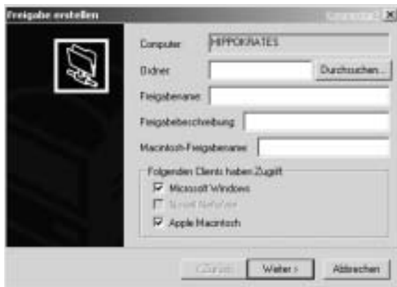
Abbildung 29.9: Erstellen einer Macintosh-Freigabe unter Windows
