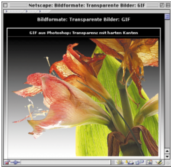
▲ Im Unterformat GIF-89a können eine oder mehrere Farben transparent gesetzt werden, jedoch ergibt sich eine harte Kontur zwischen Vorder- und Hintergrund. Hier ein transparentes GIF betrachtet in Netscape Navigator 4.5.
