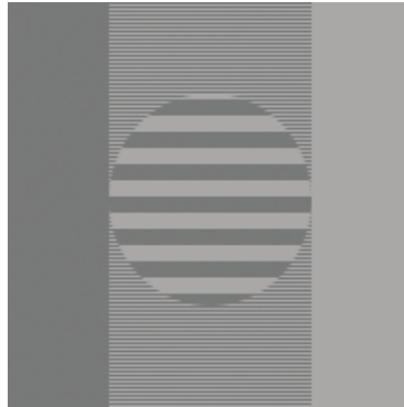
▲ Regelmäßiges Dithering mit On/off-Raster. Die Farbfläche in der Mitte entsteht aus den beiden Grautönen links und rechts. Der Kreis in der Mitte zeigt die Vergrößerung.
