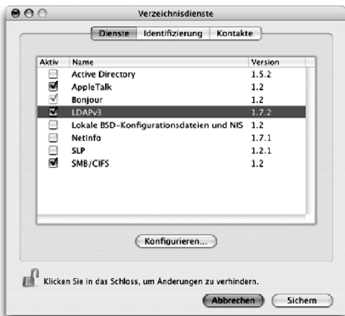
Abb. 4.25. Den Dialog zur Konfiguration der LDAP-Verbindungsparameter erreicht man im Dienstprogramm Verzeichnisdienste durch einen Doppelklick auf den Eintrag „LDAPv3“ im Bereich „Dienste“.
