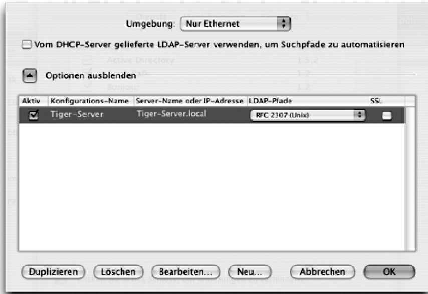
Abb. 4.26. Jedes Verbindungsprofil muss über einen Konfigurationsnamen, einen Servernamen sowie über eine Vorschrift zur Abbildung der abstrakten Open-Directory-Klassen und -Attribute auf die vom jeweiligen Verzeichnisdienst tatsächlich verwendeten Klassen und Attribute verfügen. Zusätzlich kann über eine Checkbox die SSL-Verschlüsselung aktiviert werden.
