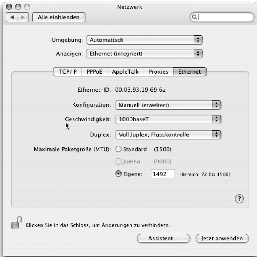
Abb. 3.3. Ab Mac OS X 10.3 können Ethernet-Schnittstellenparameter wie MTU und Übertragungsgeschwindigkeit in den Netzwerk-Systemeinstellungen konfiguriert werden.
