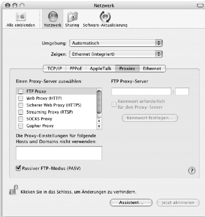
Abb. 3.43. In den Systemeinstellungen Netzwerk kann man über eine Checkbox angeben, ob der FTP-Client den Passivmodus verwenden soll oder nicht. Ebenso lässt sich hier ein FTP-Proxy angeben, falls kein direkter FTP-Zugriff erlaubt sein sollte.
