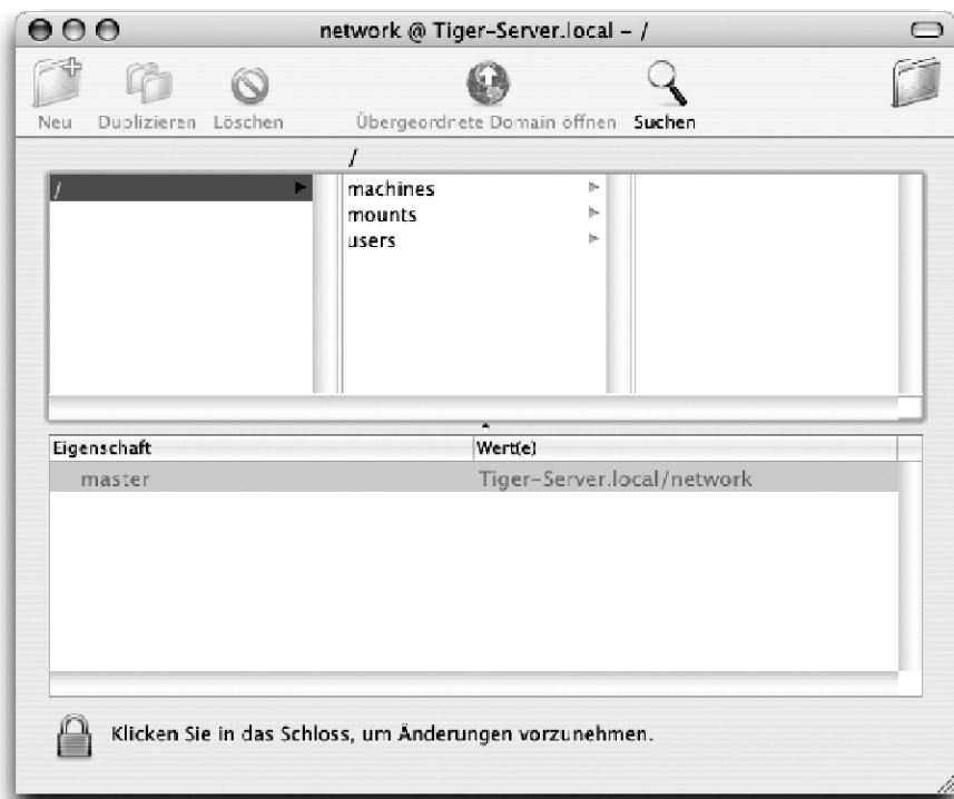
Abb. 4.15. Die Verzeichnisse auf der obersten Hierarchieebene der lokalen NetInfo-Datenbank sind beim Einsatz der NetInfo-Bridge natürlich die gleichen wie die, die über LDAP sichtbar sind.
