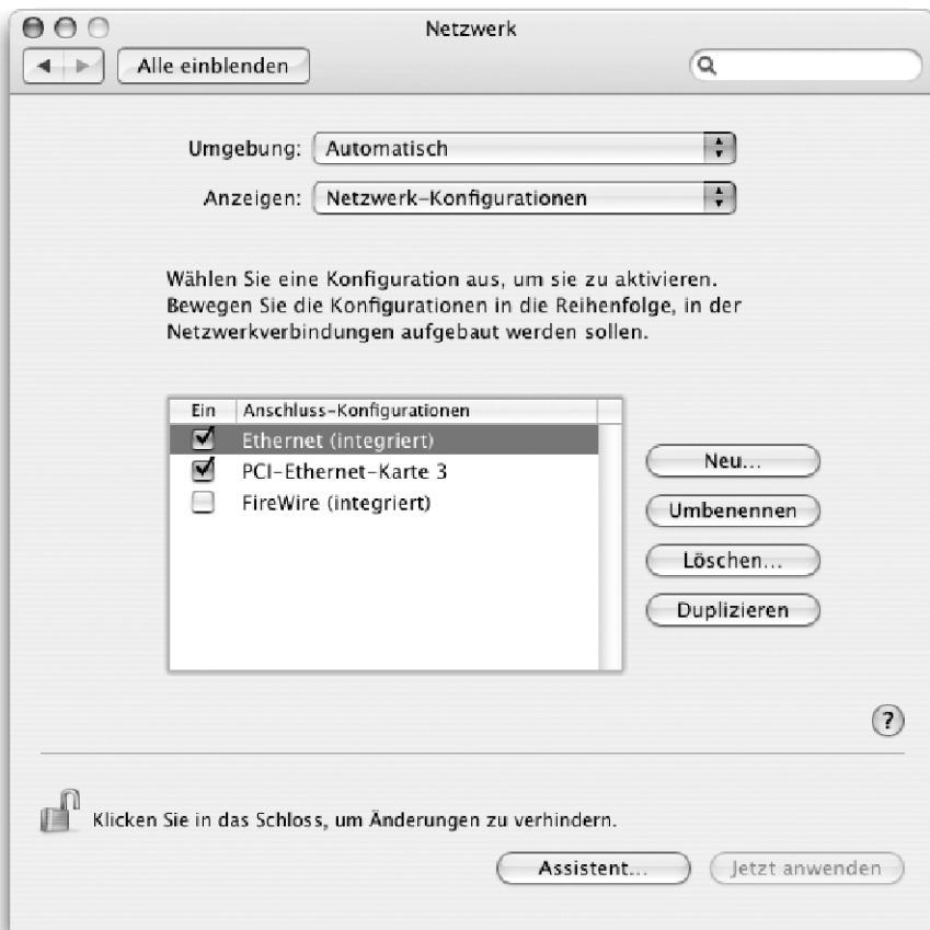
Abb. 3.28. Die externe Netzwerkschnittstelle (hier „Ethernet (integriert)“) muss eine höhere Priorität haben als die interne (hier „PCI-Ethernet-Karte 3“).
