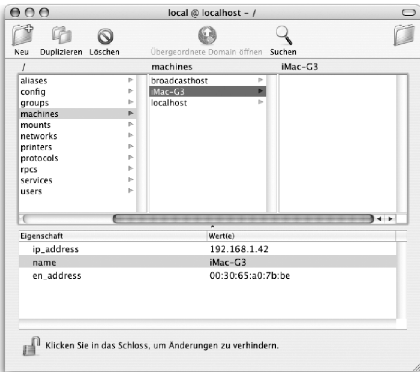
Abb. 3.20. Über Einträge im /machines-Verzeichnis der NetInfo-Datenbank unterstützt bootpd auch statisches DHCP. Die Einträge localhost und broadcasthost haben für DHCP keine Bedeutung, sondern haben eine ähnliche Funktion wie die entsprechenden Einträge in /etc/hosts auf anderen Plattformen.
