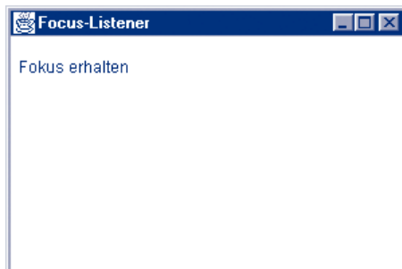
Abb. 29.4: Programm nach Erhalt des Eingabefokus
