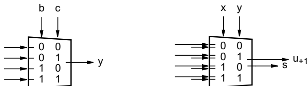
Bild 2-18. Multiplexer für Logikschaltungen (auch gern wie hier trapezförmig gezeichnet).
