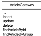
Abbildung 5-31: Beispiel für ein typisches Table Data Gateway
