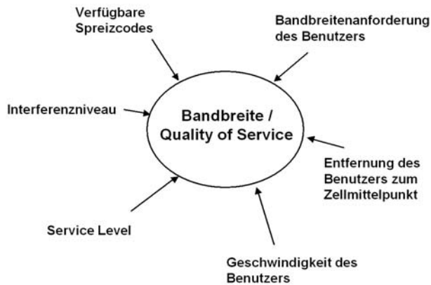
Abb. 3.23: Faktoren für die Beeinflussung der maximalen Bandbreite und des Quality of Service Level.
