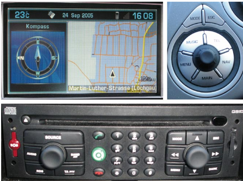
Abb. 1: Fahrzeuginformationssystem. Oben links: Display; oben rechts: Tasten mit Drehdrücksteller in der Mitte; unten: CD-Eingabe plus verschiedene Tasten und zwei Drehregler. Quelle: Frank Koller
