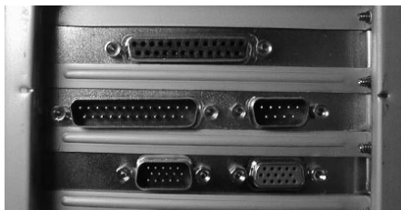
Bild S.2: Die parallele Schnittstelle befindet sich oben, die seriellen Schnittstellen in der Mitte.
