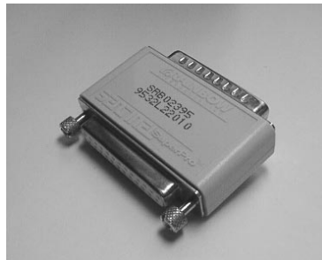
Bild D.3: Unscheinbar, aber wirksam – ohne das Dongle an der parallelen Schnittstelle läuft das geschützte Programm nicht.
