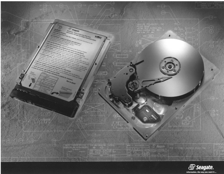
Bild H.2: Der innere Aufbau einer Festplatte
