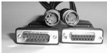
Bild M.5: Mit diesem Kabel werden MIDI-Geräte an den Gameport einer Soundkarte angeschlossen.
