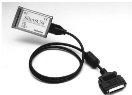
Bild S.5: Ein SCSI-Adapter im PCMCIA-Format
