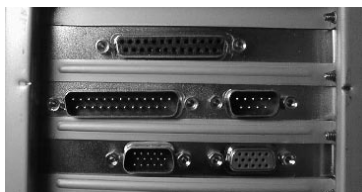
Bild C.5: In der Mitte befinden sich die beiden seriellen Anschlüsse und darüber der parallele Anschluss.
