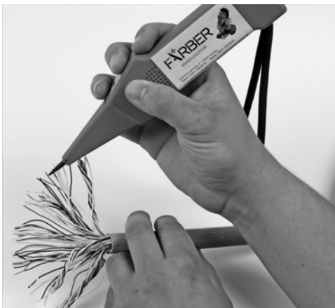
Abbildung 2.30 Arbeiten mit dem Tastkopf an einem Adernbündel
