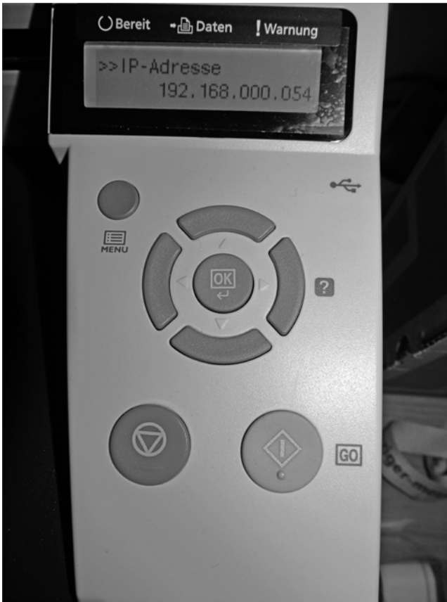
Abbildung 4.6 Netzwerkkonfiguration eines Kyocera Mita FS-1370DN über das Bedienfeld
