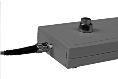
Abbildung 2.41 Eigenbau-LWL-Tester mit Adapterkabel ST
