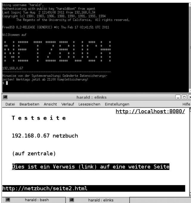
Abbildung 10.26 Putty-Terminalfenster (oben) und durch Tunnel geleitete http-Sitzung (unten)
