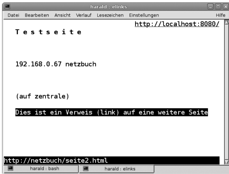
Abbildung 9.11 Per SSH-Tunnel übertragene Webseite
