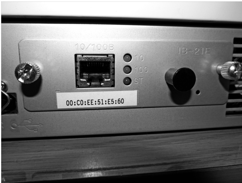
Abbildung 4.1 Aufkleber mit MAC-Adresse an einem internen Printserver
