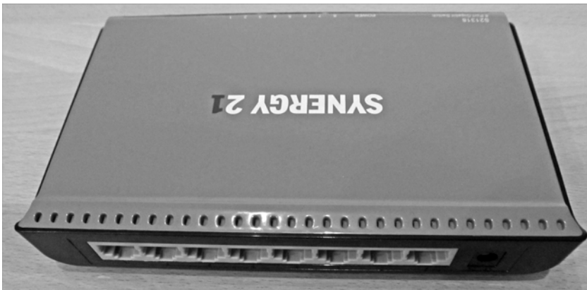
Abbildung 10.11 Tisch-Switch S21318 der Firma Synergie 21, ohne Management-Modul
