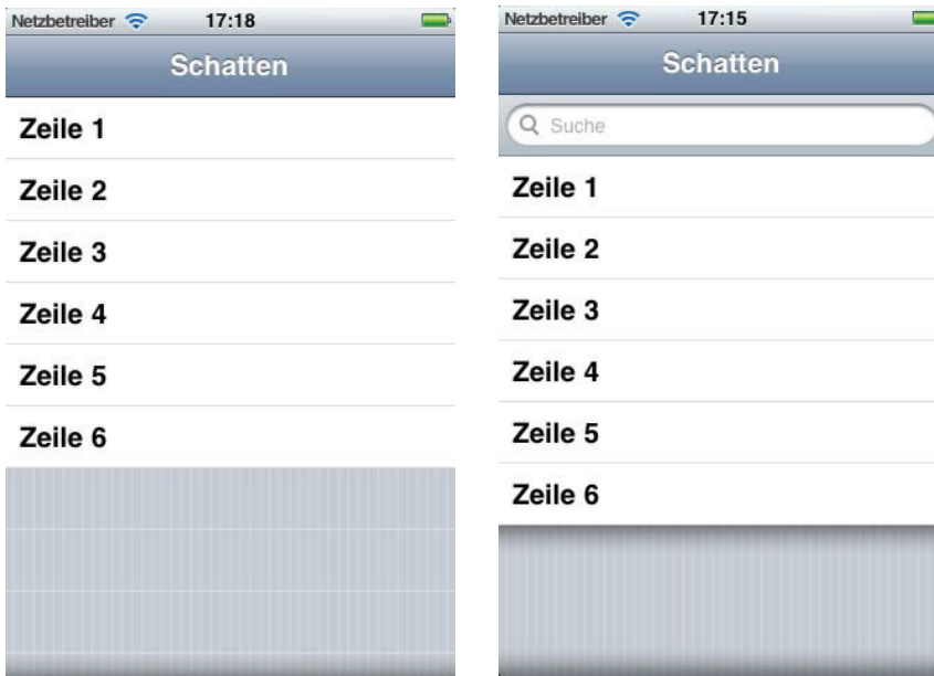
Abbildung 2.7: Table-Footer als Ausweg. Das Vorhandensein eines Table-Footers gibt uns zuverlässige Informationen über das Ende des Tabelleninhalts und sagt uns, wo wir den Schatten platzieren müssen. Außerdem eliminiert er die „Fülltrennzeichen“, die von gewöhnlichen Table-Views gezeichnet werden.
