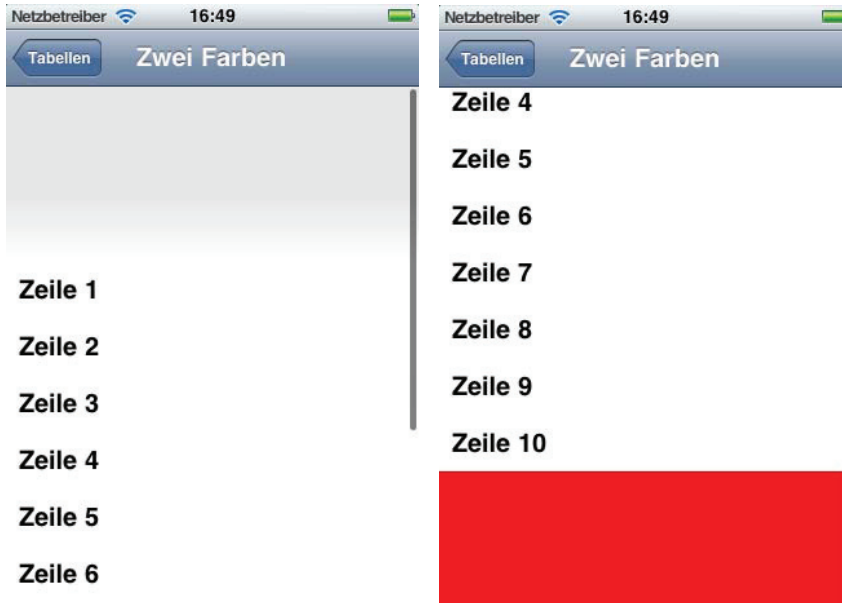
Abbildung 2.4: Table-View-Layouts mit zwei Farben. Die Lösung, die wir suchen, weist an beiden Enden der Tabelle unterschiedliche Farben auf, wie es von diesen beiden Screenshots illustriert wird. Die Tabelle hat einen weißen Gradienten oben und einen roten Hintergrund unten. Ein gewöhnlicher Table-View zeigt hinter den oberen und unteren Enden des Inhalts nur eine einzige Hintergrundfarbe.
