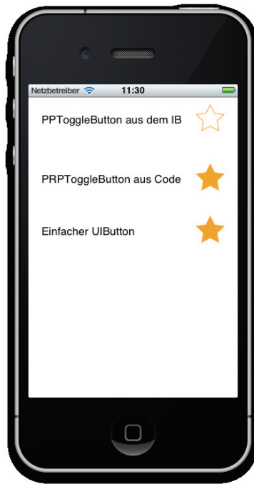
Abbildung 1.9: Ein bildbasierter An/Aus-Schalter. Zu sehen ist unser PRPToggleButton-Button in seinen An-, Aus und Hervorgehoben-Zuständen (Letzterer tritt ein, während der Finger unten ist).
