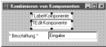
Abbildung 6.7: Die weiße Hintergrundfarbe der beiden TLabelEditCombi -Komponenten soll die von diesen eingenommene Fläche hervorheben; die in ihnen enthaltenen Einzelkomponenten lassen sich im Entwurfsmodus nicht selektieren.
