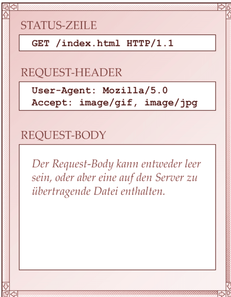
Abbildung 1: Schematischer Aufbau eines HTTP-Requests
