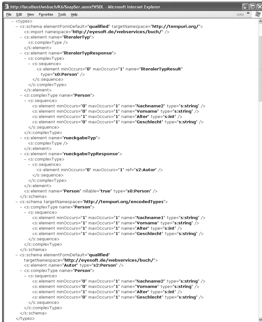
Abbildung 6.3: Im WSDL enthaltener komplexer Typ Person (für literales und encodiertes SOAP)
