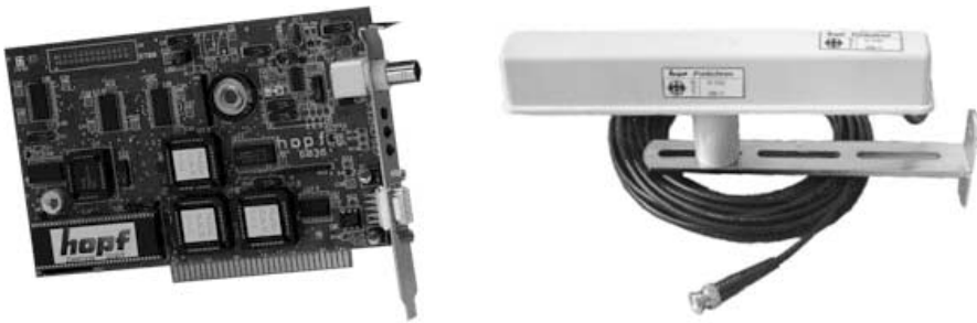
Abbildung 3-58 DCF-77-Funkuhrsystem, bestehend aus PC-Einsteckkarte und Antenne für Innenräume (Hersteller: HOPF, Bezugsquelle: www.ist-software.de )
