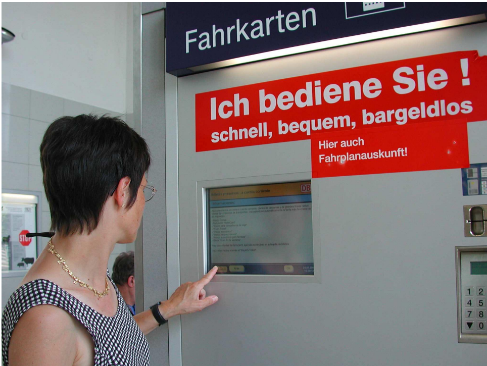
Abbildung 3.5: Berührungsempfindlicher Bildschirm (Touchscreen) an einem Verkaufsautomaten
