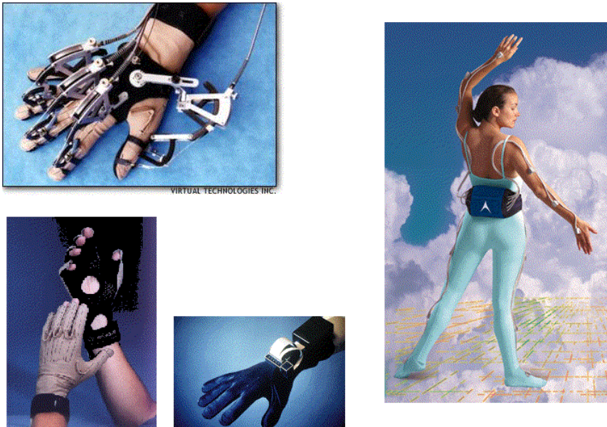
Abbildung 3.10: Verschiedene Ein- und Ausgabekomponenten. Links oben ein Aufnahmegerät für Handbewegungen, darunter ein haptisches Interface für eine Hand, rechts ein Datenanzug.
