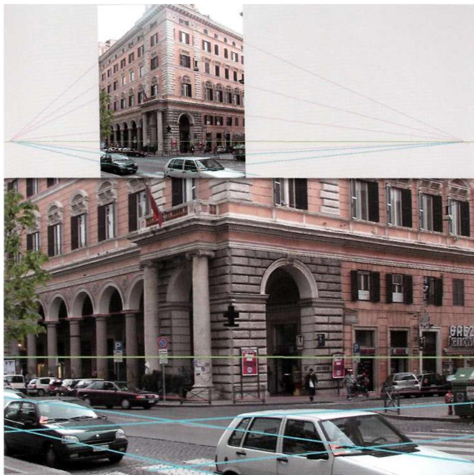
Anschließend verbinden Sie die beiden Fluchtpunkte mit einer Gerade, dem Horizont (grün). Von den Fluchtpunkten ausgehend konstruieren Sie zunächst auf einer Seite zwei der Fluchtenlinien, die die Bodenkanten des Quaders bilden (blau). Danach wiederholen Sie das mit Verbindungen zum Fluchtpunkt auf der anderen Seite. Sie haben nun ein auf dem Boden liegendes Rechteck, das der Bildperspektive angepasst ist.
