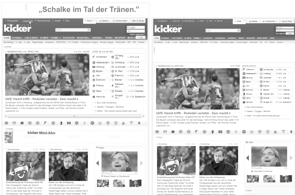
Bild 7.13 Mit (rechts) und ohne (links) installiertes Adblock Plus-Add-On: Frei von Werbung, ist die Webseite nicht nur übersichtlicher, sondern benötigt auch weniger Ladezeit und somit weniger Bandbreite.
