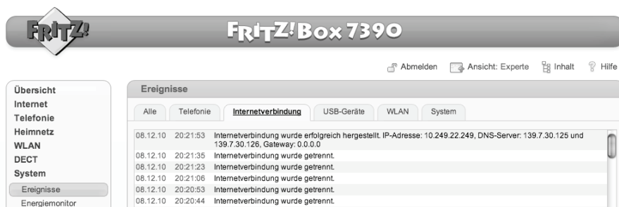
Bild 7.10 Weitere Informationen zur Verbindung finden Sie im Bereich System/Ereignisse im Register Internetverbindung – im Beispiel mit aktualisiertem Datum und aktualisierter Uhrzeit.
