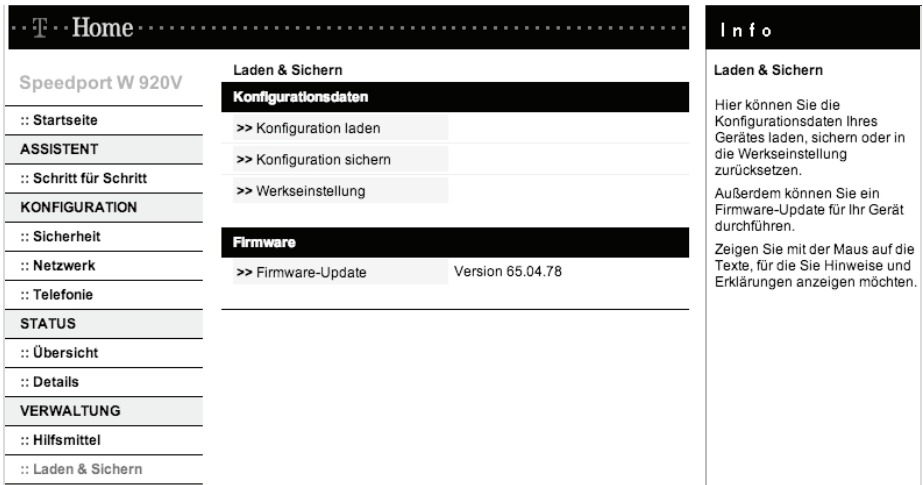
Bild 3.17 Sinnvoll: Über das Menü Konfigurationsdaten/Konfiguration sichern speichern Sie die Konfiguration des Speedport auf die Festplatte des PCs.
