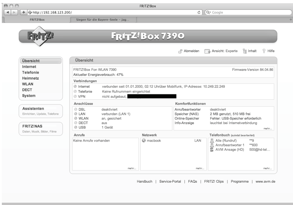
Bild 7.9 Zeitraum im Blick: Im Startdialog informiert die FRITZ!Box über die Verbindungsdauer.
