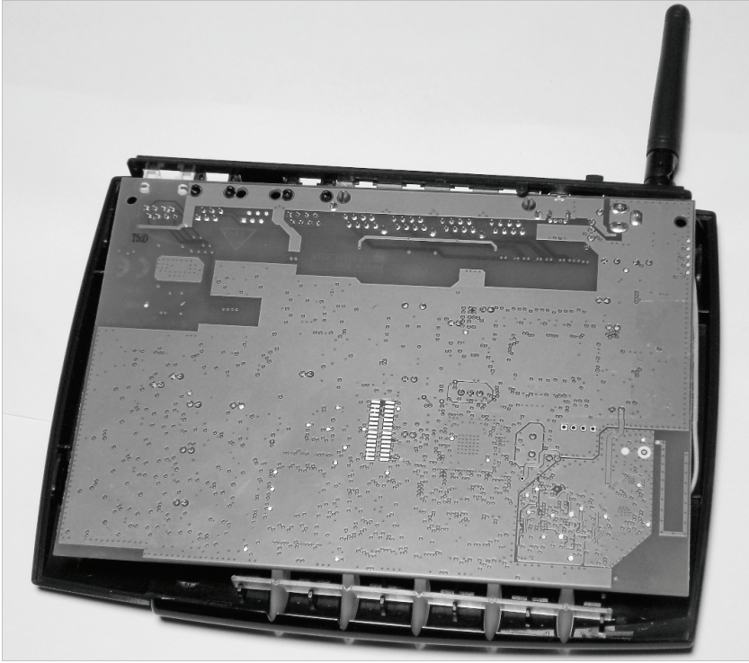
Bild 1.4 Nun lässt sich der Boden des Gehäuses abnehmen – die Platinenunterseite der FRITZ!Box ist zu sehen.
