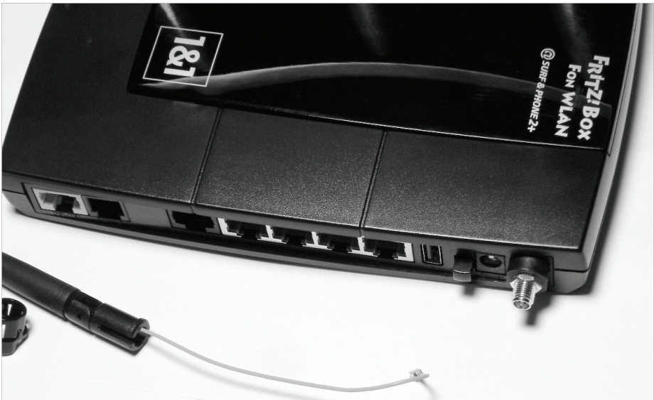
Bild 1.7 Umbau erfolgreich: Ist das Gehäuse verschlossen, kann die neue Antenne angeschraubt werden.
