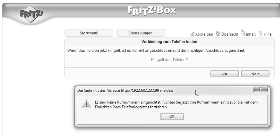
Bild 9.6 Nach der Klingelbestätigung will die FRITZ!Box partout eine Rufnummer für die angeschlossene Türsprechanlage einrichten.
