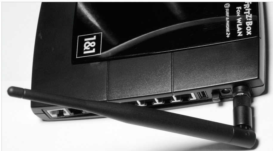
Bild 1.8 Ist die neue Antenne auf der Buchse angeschraubt, können Sie die FRITZ!Box wieder in Betrieb nehmen.
