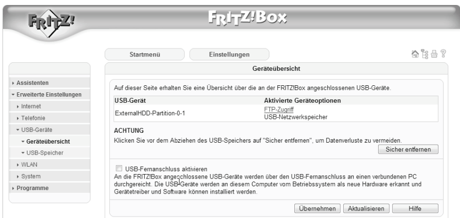
Bild 4.21 Zunächst wird die USB-Festplatte mit der Bezeichnung ExternalHDD-Partition-0-1 erkannt – abhängig von der installierten Firmware und dem FRITZ!Box-Modell kann diese Bezeichnung auch abweichen.
