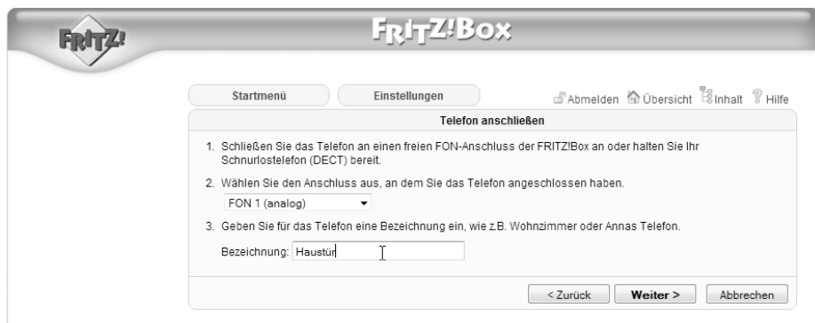
Bild 9.5 Zunächst wählen Sie den passenden Anschluss aus und benennen ihn wunschgemäß.
