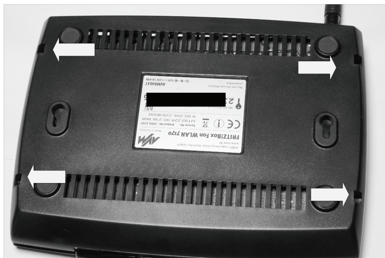
Bild 1.3 An diesen vier Stellen drücken Sie mit einem flachen Schraubendreher sanft die Plastiklaschen, damit sich das Gehäuse der FRITZ!Box öffnen lässt.
