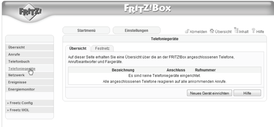
Bild 9.3 Im Telefonkonfigurationsdialog klicken Sie zunächst auf die Schaltfläche Neues Gerät einrichten , um die Türsprechanlage als analoge Nebenstelle in die FRITZ!Box zu integrieren.
