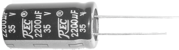
Bild 8.2 Kondensatorbeinchen unterscheiden sich in ihrer Länge: Hier muss das kurze Beinchen an die Masse (-), das längere an die Anode (+) angeschlossen werden.
