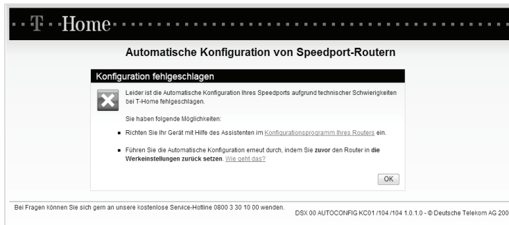
Bild 3.8 Schlägt die automatische Einrichtung des Speedport-Routers fehl, prüfen Sie erneut dessen Anschlüsse sowie die des DSL-Splitters und auch die Verkabelung.
