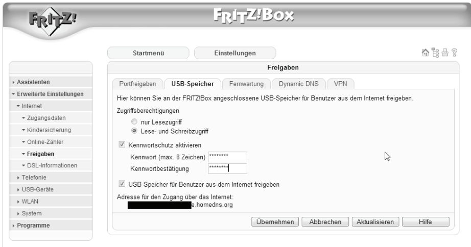
Bild 4.23 Für den Zugriff aus dem Internet ist eine eingerichtete dynamische Adresse bei dyndns.org oder bei alternativen Anbietern notwendig, was im Register Dynamic DNS erledigt wird.
