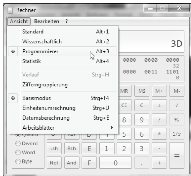
Bild 8.15 Unter Windows 7 muss der Rechner erst über Ansicht in den Programmiermodus umgeschaltet werden, damit Sie die Dezimal- in Hexwerte umrechnen können.
