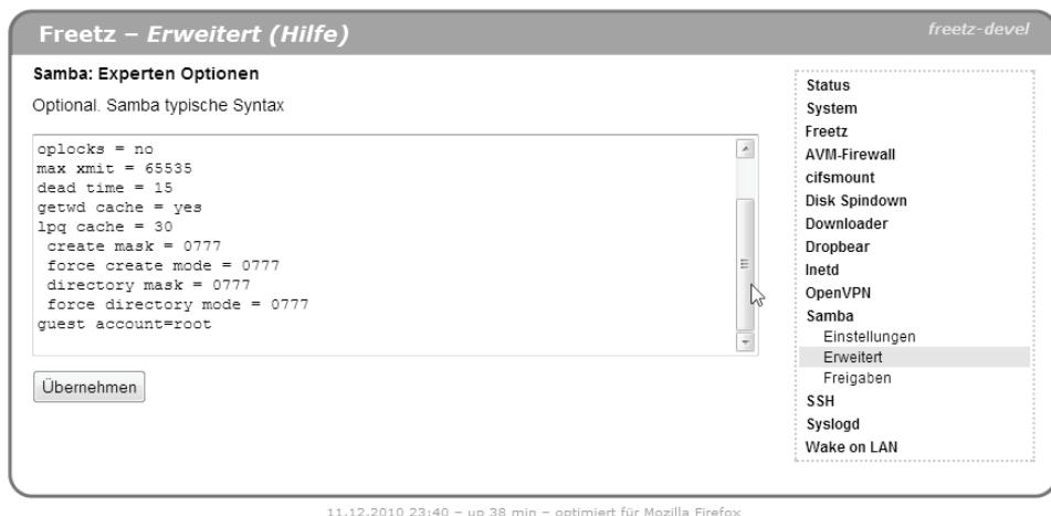
Bild 4.40 Je nach verwendetem Betriebssystem im Heimnetz setzen Sie die entsprechenden Experten Optionen . Der Schalter guest account=root sorgt für den Zugriff auf das Root-System.
