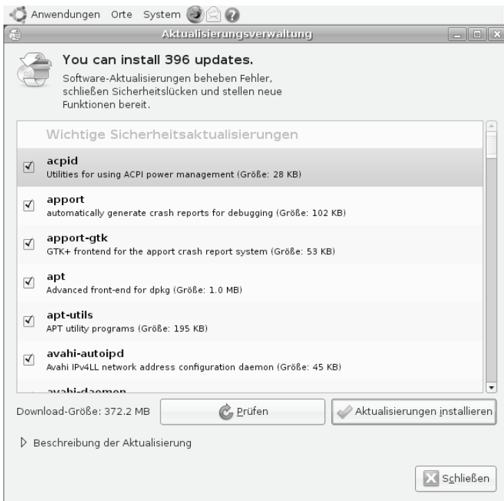
Bild 4.2 Nach dem Start der Aktualisierungsverwaltung klicken Sie zunächst auf die Prüfen -Schaltfläche. Stehen Updates bereit, starten Sie die Installation per Klick auf Aktualisierungen installieren .
