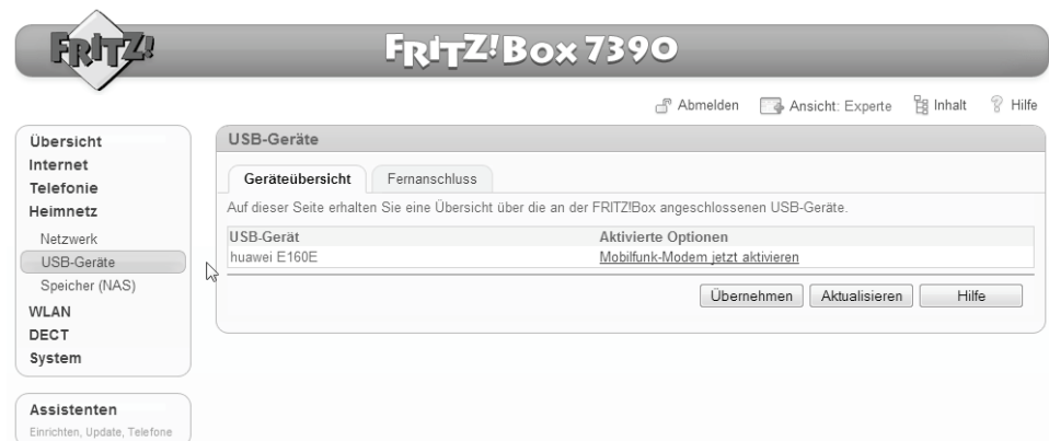
Bild 7.5 Unterstützung vorhanden: Wird der eingesteckte USB/UMTS-Datenstick als Datenmodem erkannt, können Sie nun die Mobilfunkeinstellungen für den Internetzugang einrichten.
