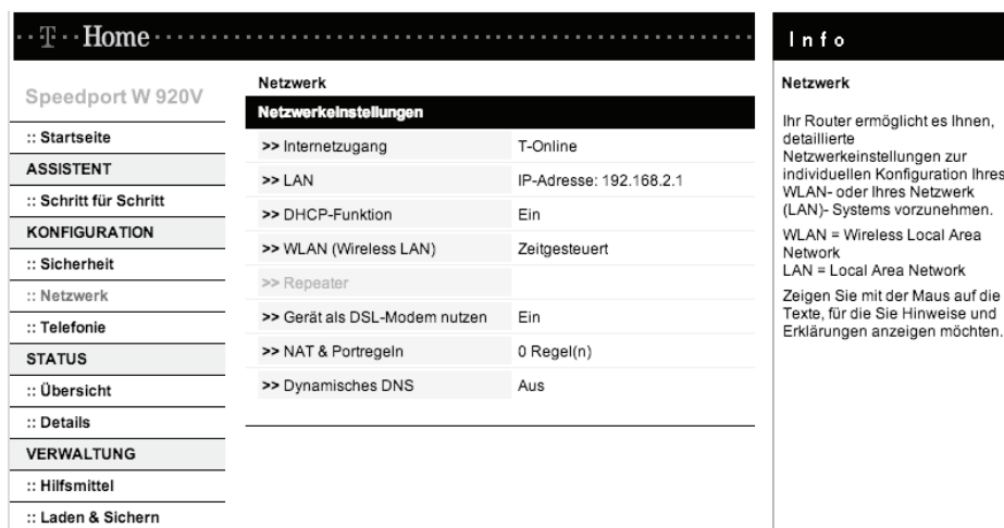
Bild 3.14 Die manuelle Konfiguration des Internetproviders beim W 920V ist im Menü Konfiguration/Netzwerk/Netzwerkeinstellungen bei Internetzugang versteckt.
