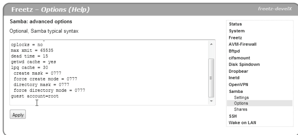
Bild 6.15 Um überhaupt von Windows aus Schreibzugriff auf die Samba-Freigabe zu bekommen, muss der Eintrag guest account=root im Menübereich Options eingetragen werden. Fehlt dieser Eintrag, ist nur lesender Zugriff auf die Freigaben im Heimnetz möglich.
