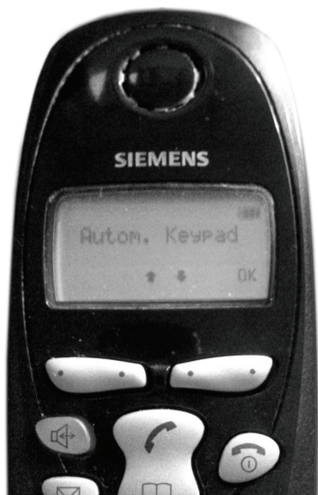
Bild 9.15 Erst nach dem Umstellen des Keypad-Schalters werden beliebige Tastensequenzen ohne weitere Interpretation durch das Telefon an die FRITZ!Box durchgereicht.
