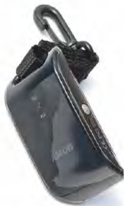
Abbildung 4.88 Der AMOD AGL3080 GPS Photo Tracker ist ein kleines, leichtes Gerät, mit dem Sie GPS-Koordinaten aufnehmen und mit der mitgelieferten Software auslesen können. Sie können es ganz einfach an der Kamera befestigen.
