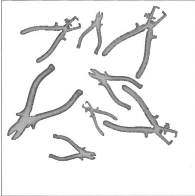
Bild 35.6: Das Bild enthält zwei Zangen in jeweils vier unterschiedlichen Drehlagen und Größen. Die Tabelle der c_i -Werte zeigt hier keine so deutlichen Unterschiede. Die Parameter c_3 und c_4 machen in diesem Beispiel aber eine Trennung der Klassen möglich.
