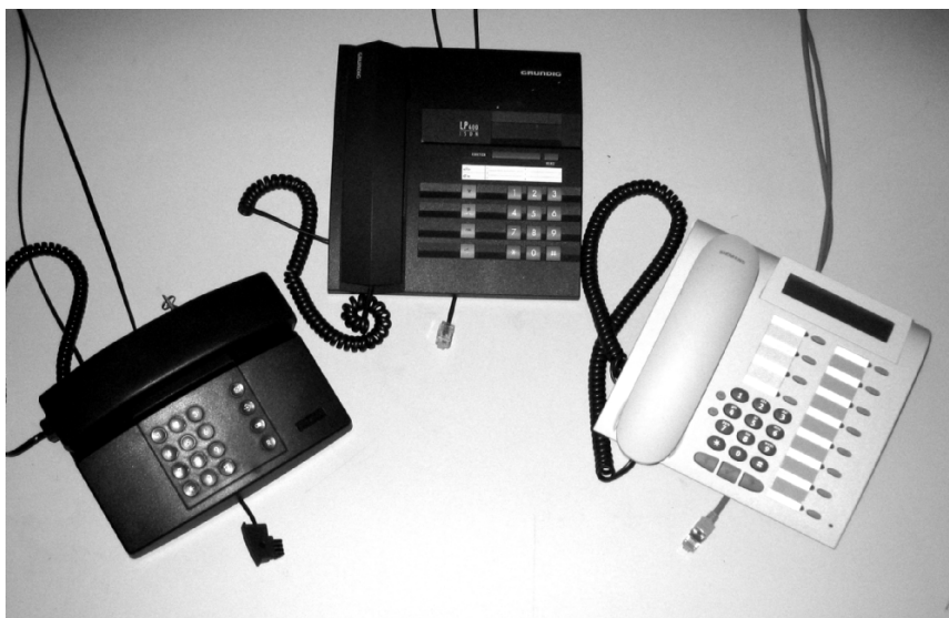
Abbildung 11.4. Drei Generationen von Telefonen, äußerlich kaum zu unterscheiden: links analoges Telefon mit TAE-Stecker, in der Mitte ISDN-Telefon mit RJ45-ISDN-Stecker, rechts Internet-Telefon mit RJ45-Ethernet-Anschluss
