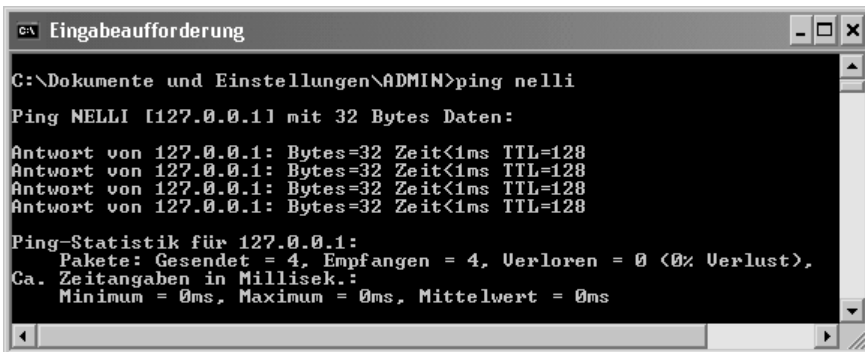
Abbildung 7.5: Überprüfung der Verbindung mit einem Ping
