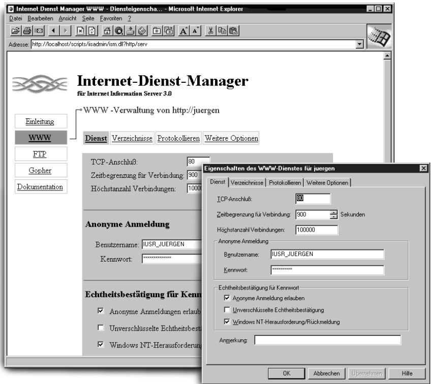
Abbildung 3.10: Der Internet Information Server 3 lässt sich entweder direkt über einen Webbrowser konfigurieren, dazu muss allerdings der Internet Service Manager aktiviert sein oder man nutzt zur Konfiguration der verschiedenen Internetdienstleistungen die üblichen Windows-Panels. Diese sind zumeist etwas übersichtlicher, können jedoch nur am lokalen Rechner aufgerufen werden.
