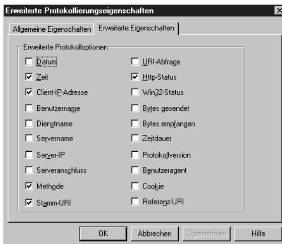
Abbildung 3.12: Die Protokolldienste des Internet Information Servers sind ungewöhnlich umfangreich und können den eigenen Bedürfnissen genau angepasst werden. Das Logfile sollte jedoch nicht in ein öffentlich zugängliches Verzeichnis geschrieben werden, da dies aus Datenschutzgründen problematisch ist.
