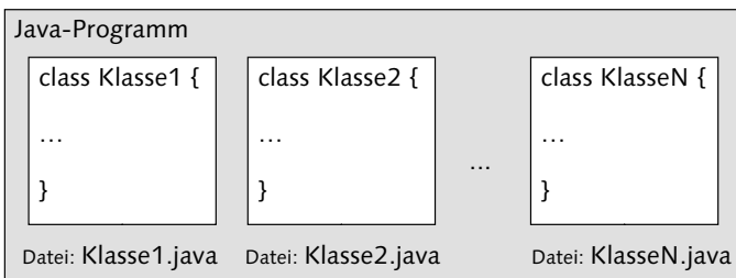
Abbildung 1.21 Aufbau eines Java-Programms
