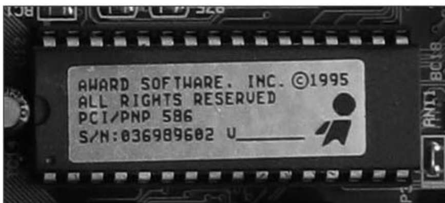
Abbildung 1.9 Ein BIOS-Chip (Quelle: http://commons.wikimedia.org/ )
