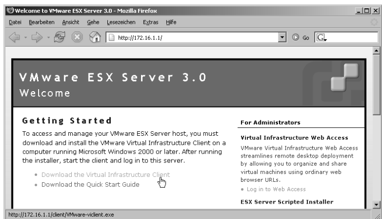
Abbildung 9.8: Über einen Browser kann der Virtual Infrastructure Cli- ent vom ESX Server heruntergeladen und installiert werden
