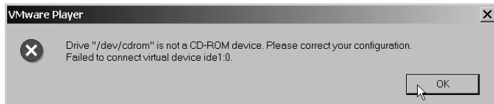
Abbildung 5.10: Vor allem bei älteren Konfigurations- dateien kann es beim Wechsel von Linux zu Windows Prob- leme geben
