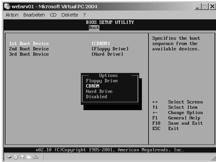
Abbildung 2.10: Mit der Taste [Entf] gelangen Sie ins emulierte CMOS-Setup, in dem Sie die Boot- reihenfolge ändern können
