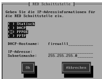
Abbildung 3.19: PPPoE wird für ein DSL-Modem ver- wendet. Für einen Router muss hier eine passende IP- Adresse eingetragen werden
