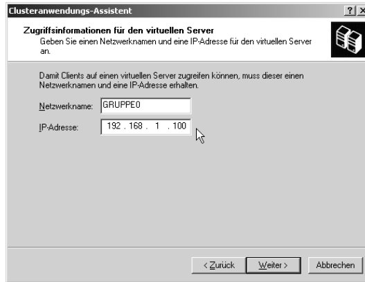
Abbildung 8.33: Als neue Ressourcen werden ein Netzwerkname und eine virtuelle IP-Adresse konfiguriert, später kommt eine Freigabe dazu
