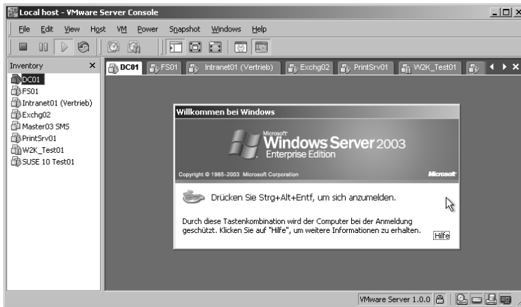
Abbildung 4.4: Die VMware Server Console ermöglicht die Fernverwaltung des VMware Servers von jedem Client im LAN
