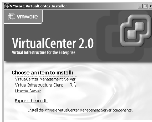
Abbildung 9.21: Der Virtual Center Management Server setzt einen Lizenz- server voraus, der automatisch mitins- talliert werden kann
