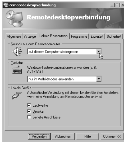
Abbildung 4.41: Beim Verbinden zu einem Gast über Remotedesktop können lokale Lauf- werke oder Sound- karten durchgereicht werden
