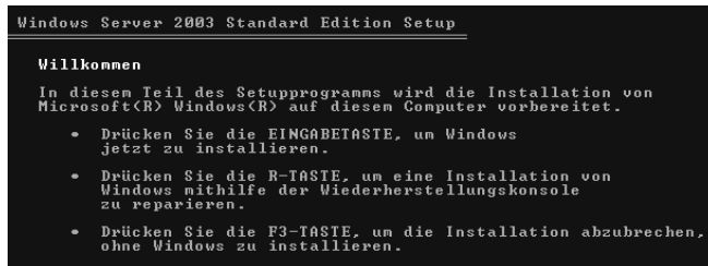
Abbildung 6.9: Mit der Windows- Boot-CD und der Taste R gelangt man in die Kommando- zeile der Wiederher- stellungskonsole von Windows
