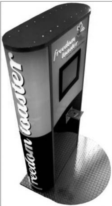
Abbildung 2.6 Der »Freedom Toaster«. Mit ihm lassen sich verschiedene Distributionen kostenlos auf einen selbst mitgebrachten Rohling brennen.
