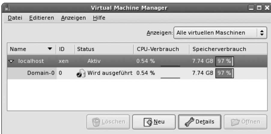
Abbildung 28.8 Der »VMM«. Es ist noch keine Verbindung zu einem Hypervisor hergestellt worden.
