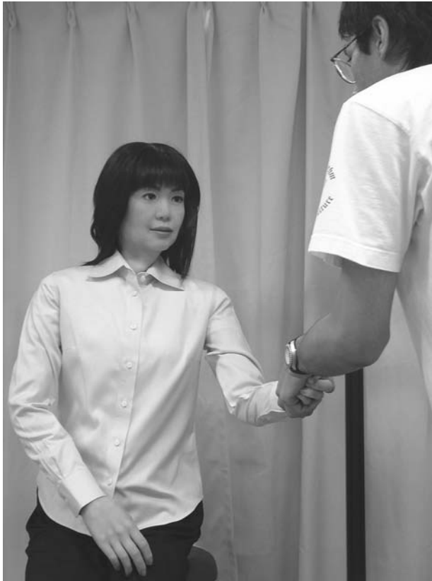
Abbildung 6-5: Ein täuschend echter persönlicher Roboter Repliee Q1 (Hiroshi Ishiguro, Universität Osaka, 2005). Die Roboterfrau kann gestikulieren und simuliert sogar das Atmen. Sie könnte eine Empfangsdame sein und einen Auskunftskiosk ersetzen.
