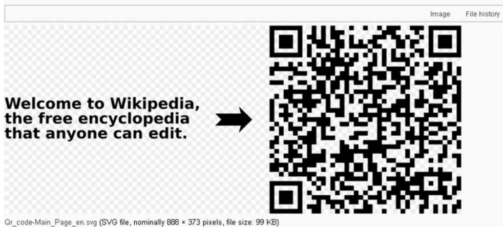
Abbildung 3-6: Zweidimensionaler Strichcode: Dekodieren des aufgenommenen Codes leitet das mobile Telefon direkt zur Zielinformation – ein physikalischer Hyperlink (Quelle: Wikipedia-Seite zum QR-Code vom 29. 2. 2008).
