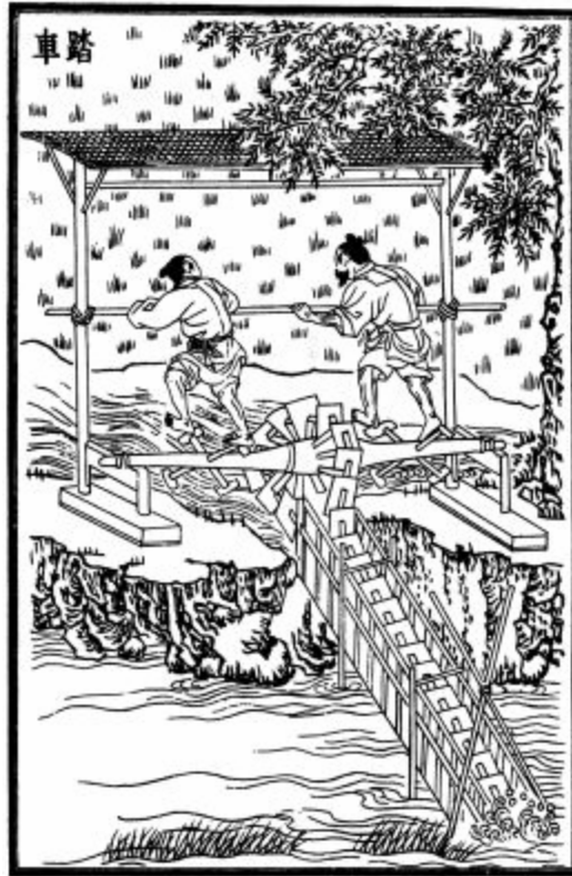
© Abb. 5: Tretrad für Bewässerungsanlage; nach einer Darstellung aus dem 17. Jahrhundert
