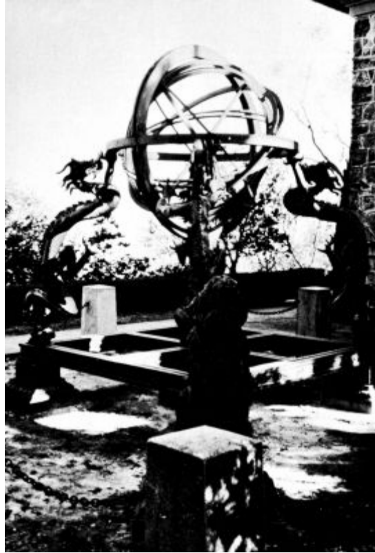
© Abb. 9: Äquatorial-Armillarsphäre zur Bestimmung der Sternorte; nach einem Entwurf von Kuo Shou-ching (um 1276), nachgebaut vermutlich von Huang-fu Chung-ho (um 1437). Observatorium auf dem Purpur-Berg bei Nanking
