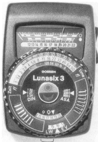
Abb. 20: Ein bekannter, heute noch produzierter Vertreter der CdS-Belichtungsmesser. Der kleine CdS-Fotowiderstand ermöglichte erstmals die Konstruktion besonders empfindlicher und dennoch ziemlich robuster Geräte. Der Lunasix 3 gehört zu den empfindlichsten Belichtungsmessern, obwohl er keine verstärkende Elektronik besitzt.
