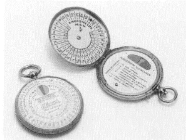
Abb. 18: Ein chemischer Belichtungsmesser aus der Zeit der Jahrhundertwende. Die Genauigkeit dieser Geräte war noch recht bescheiden, so dass noch viele Jahre die weitverbreiteten Belichtungstabellen die zuverlässigeren Helfer waren. Aufnahme: Urs Tillmanns
