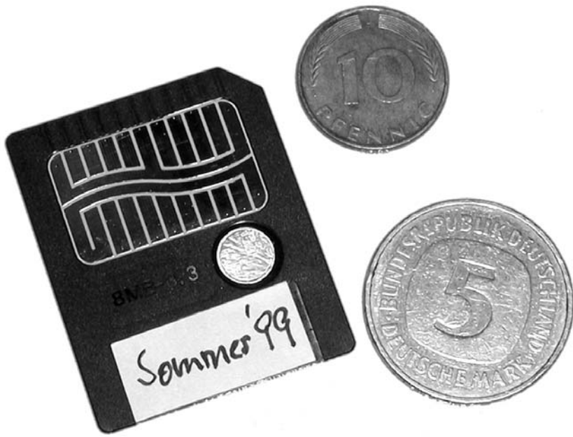
Bild 3.5: Die SmartMedia-Karte. Deutlich erkennt man im oberen Bereich den Speicherchip mit den gebogenen Linien. Der Punkt in der Mitte rechts stellt einen Schreibschutz dar. Dabei handelt es sich um einen kleinen Aufkleber aus Alufolie. Unten ist noch Platz für ein kleines Schriftfeld.
