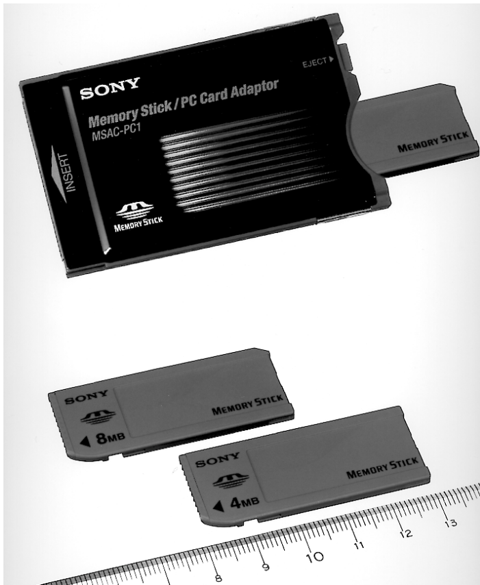
Bild 3.7: Sonys Memory Stick. Mit diesem Medium will Sony nicht nur digitale Kameras ausstatten. Der Memory Stick soll ein universell einsetzbarer Datenspeicher werden. Er soll in Zukunft in Notebooks, Walkmans, digitalen Videokameras und Fotoprintern stecken.
