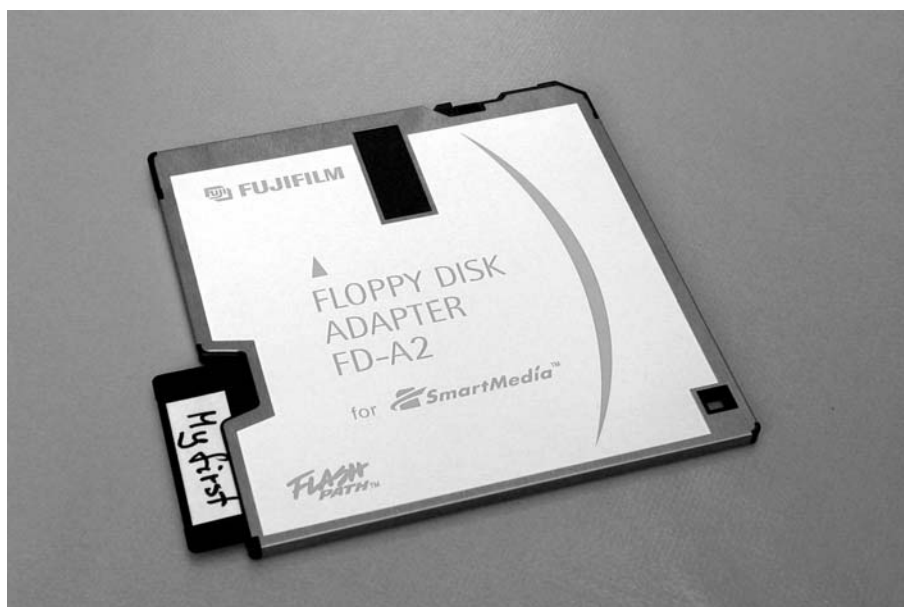
Bild 3.6: Der FlashPath-Adapter für die SmartMedia-Karten. Mit ihm mutiert die SmartMedia zur 3,5-Zoll-Diskette. Einfacher geht es kaum noch.
