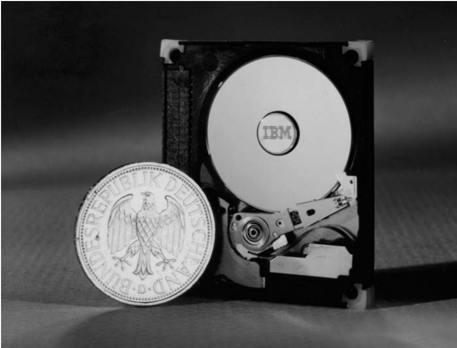
Bild 3.2: Das Microdrive von IBM. Es handelt sich wirklich um eine Festplatte. Die Platte selbst ist kaum größer als ein Markstück.
