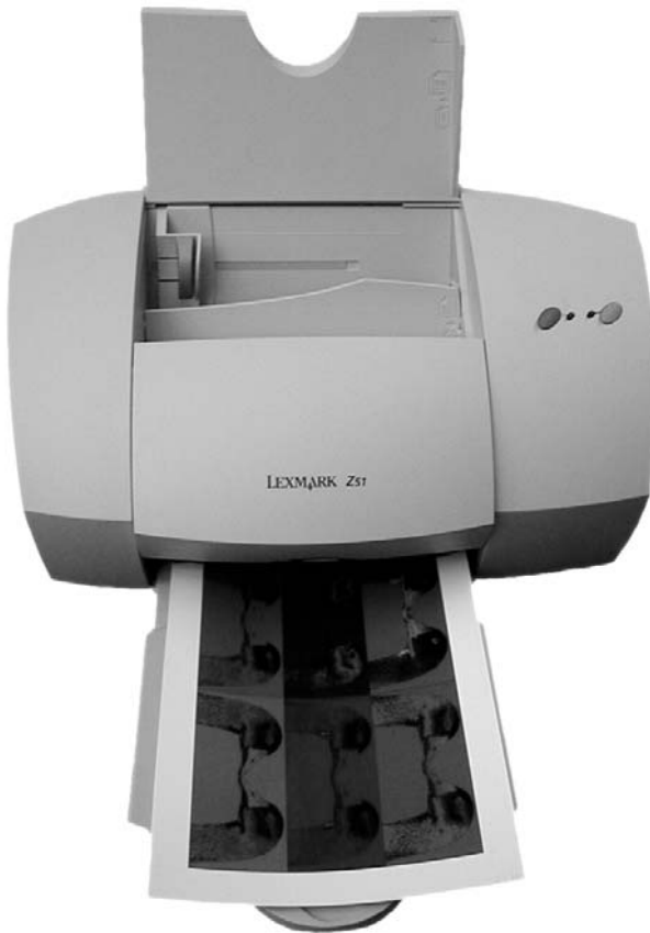
Bild 8.1: Tintenstrahldrucker, wie der hier abgebildete Lexmark Z51, können auf entsprechendem Papier Fotos drucken, die sich durchaus mit Papierabzügen messen lassen. Dabei ist der Tintenstrahldrucker nicht auf ein Fotoformat eingeschränkt, sondern kann auch auf DIN-A4-Format drucken.
