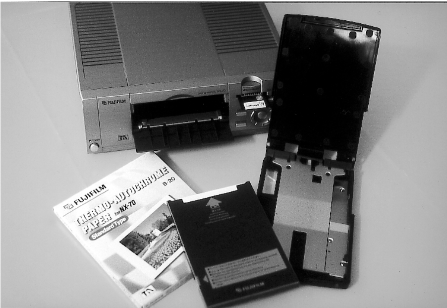
Bild 8.3: Der Autochrome-Drucker NX 70 von Fuji benötigt spezielles Autochrome-Papier. Rechts im Bild ist die Papierkassette zur Aufnahme des Papiers zu erkennen. Der Drucker druckt die Bilder direkt von einer SmartMedia-Karte.
