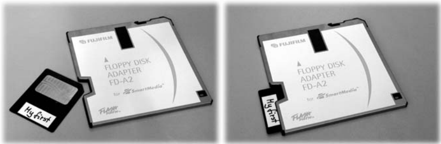
Bild 6.7: Der Diskettenadapter für die SmartMedia-Karten. Den Adapter inklusive SmartMedia stecken Sie einfach ins Diskettenlaufwerk, und schon können Sie auf Ihre frisch aufgenommenen Bilder zugreifen.
