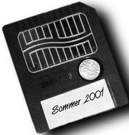
Bild 5.7: Die SmartMedia-Karte mit aufgebrachtem Schreibschutz. Man erkennt deutlich den runden Aluminium-Aufkleber.
