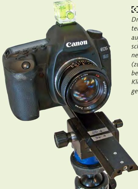
**☒** Hat man den Drehpunkt ermittelt, kann man sich auf dem Einstellschlitten eine geeignete Markierung (zum Beispiel ein besonders robustes Klebeband) anbringen.
